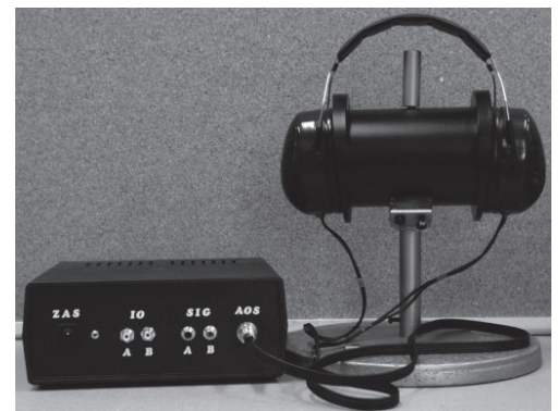
Rys. 6. Aktywny ochronnik słuchu przeznaczony do pracy na stacjonarnych stanowiskach pracy
