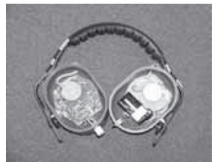
Rys. 1. Prototyp nausznika przeciwhałasowego z regulowanym tłumieniem
