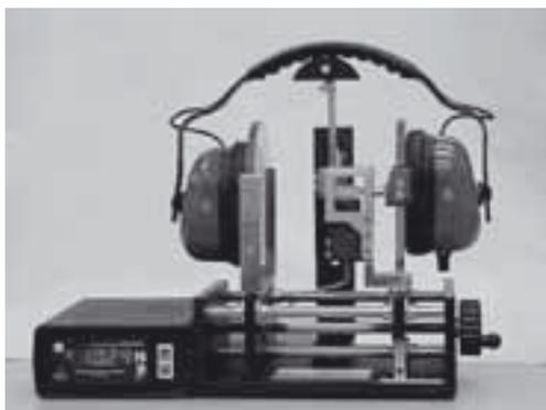
Rys. 6. Pomiar siły docisku i ciśnienia poduszek uszczelniających prototypów nauszniaków przeciwhałasowych z regulowanym tłumieniem FASER N1-E3
