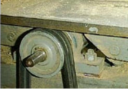
Fot. 1. Nieosłonięte koło przekładni pasowej Fot. 1. Uncovered belt pulley
