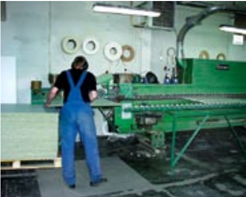
Fot. 2. Równa i uprzątnięta posadzka oraz właściwe oświetlenie stanowiska pracy Fot. 2. Even and cleared floor as well as proper lighting of a workstand
