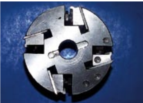
Fot. 4. Właściwy kształt narzędzia dla obrabiarek do drewna z posuwem ręcznym Fot. 4. Proper shape of a tool for handfed woodworking machines
