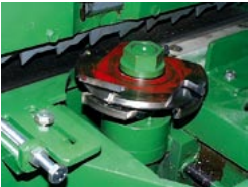
Fot. 3. Niewłaściwy kształt narzędzia dla obrabiarek do drewna z posuwem ręcznym Fot. 3. Improper shape of a tool for handfed woodworking machines
