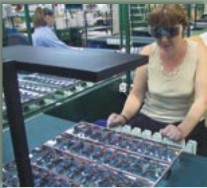
Fot. 6. Stanowisko montażu rastrów oświetlone modelem oprawy z asymetryczną płytą światłowodzącą
