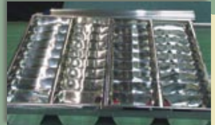
Fot. 4. Widok zmontowanego rastra z widocznymi odbłaskami Fot. 4. A view of a louvre with visible reflections
