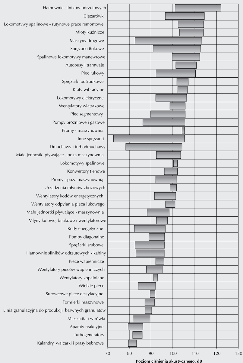
Rys. 3. Hałas infradźwiękowy emitowany przez wybrane maszyny i urządzenia przemysłowe oraz środki transportu zakresy mierzonych średnich wartości poziomu ciśnienia akustycznego skorygowanego charakterystyką częstotliwościową G (wg badań IMP i CIOP) [13]
