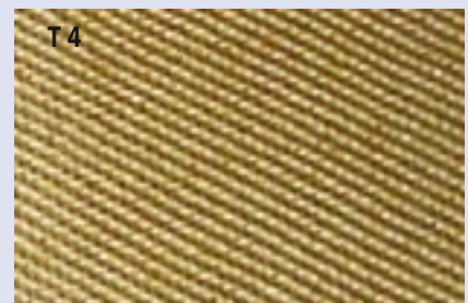
Fot. 3. Próbkę tkanin szklanych pokrytych folią aluminiową (materiał odniesienia o symbolu T6) i vermikulitem (materiał odniesienia o symbolu T4)
