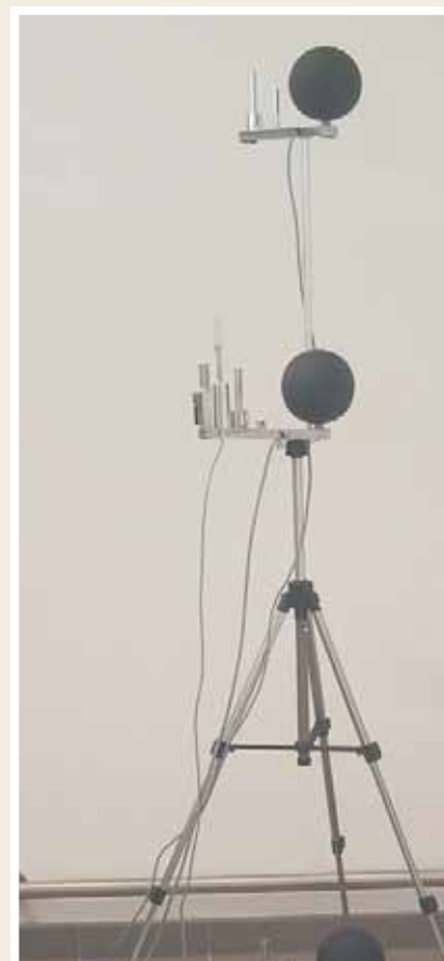
Rys. 2. Zestaw czujników do pomiaru WBGT w środowisku niejednorodnym
