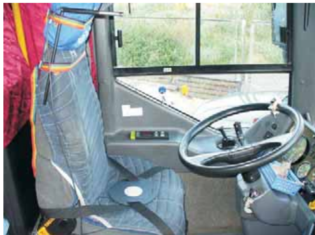
Fot. 3. Lokalizacja przetworników drgań i mikrofonu Photo. 3. Location of accelerometers and the microphone
