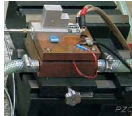
Fot. 1. Moduł diody laserowej wykonanej na bazie InGaAs/GaAs na zakres 940 nm [2]
