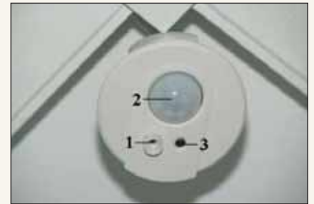
Rys. 2. Widok multiczuJNIKA systemu A składającego się z czujników: 1 – światła, 2 – ruchu, 3 – podczerwieni Fig. 2. A multisensor of System A: 1. light sensor, 2. motion sensor, 3. infrared sensor
