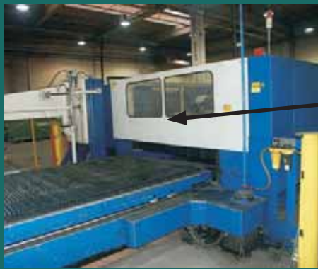
Fot. 1. Urządzenie laserowe do cięcia materiałów Fot 1. Laser device for materials cutting
