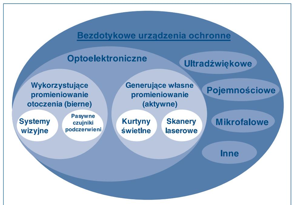
Rys. 1. Klasyfikacja bezdotykowych urządzeń ochronnych
