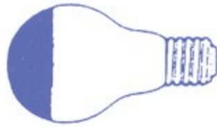
Rys. 2. Żarówka ze zwierciadlaną (zaczernioną) kopułą
