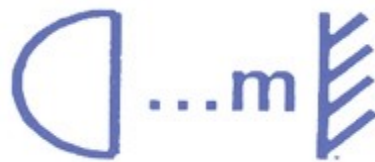
Rys. 3. Symbol określający minimalną odległość od powierzchni oświetlanej (w metrach)
