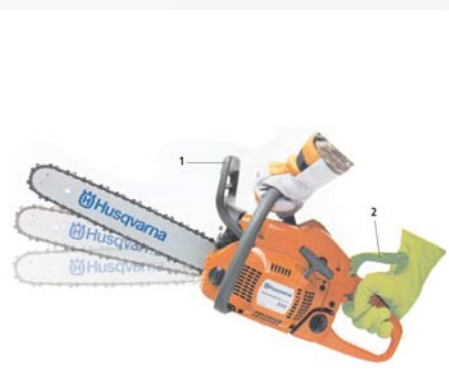
Fot. 4. Pilarka z dwoma dźwigniami uruchamiającymi hamulec piły łańcuchowej: 1 – dźwignia sprzężona z osłoną przednią, dodatkowa dźwignia (osłona) przy uchwycie tylnym pilarki [7]
