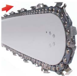
Fot. 1. Piła łańcuchowa poruszająca się po prowadnicy pilarki
