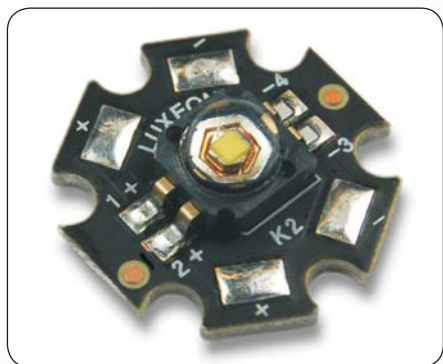
Rys. 2. Widok przykładowej diody dużej mocy [3]
