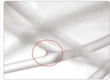
Rys. 2. Depozycja kropli aerozolu DEHS pomiędzy dwoma włóknami w procesie filtracji przy prędkości przepływu 5 cm/s i stężeniu aerozolu 10^6 cząstek/cm 3
