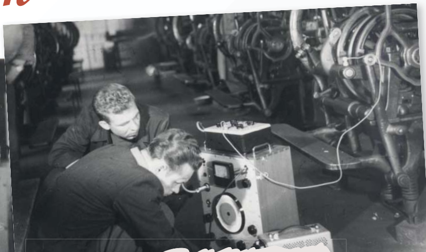
Analiza hałasu występującego na hali fabrycznej za pomocą typowego zestawu aparatury firmy Brüel. Ok. 1960 r.
