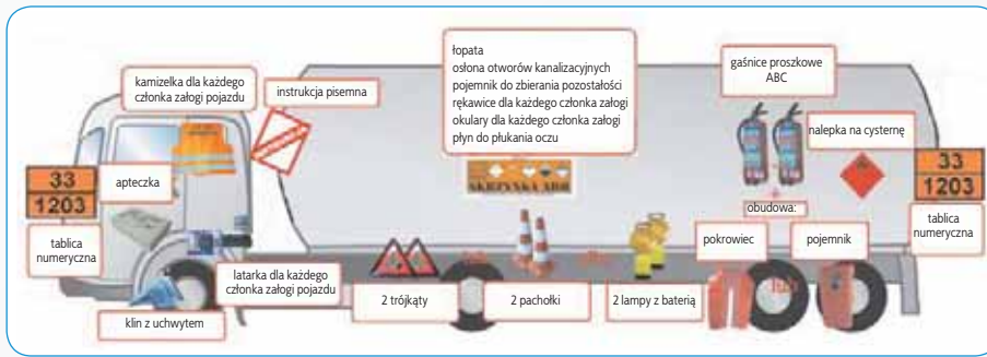
Rys. 7. Wyposażenie jednostki transportowej Fig. 7. The equipment of a transport unit
