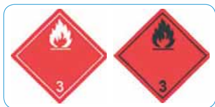
Rys. 3. Wzór nalepki dla klasy 3 Fig. 3. A sample class 3 label
