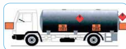
Rys. 5. Oznakowanie pojazdu-cysterny przewożącej różne paliwa, np. UN 1202 i UN 1203 w osobnych komorach cysterny
