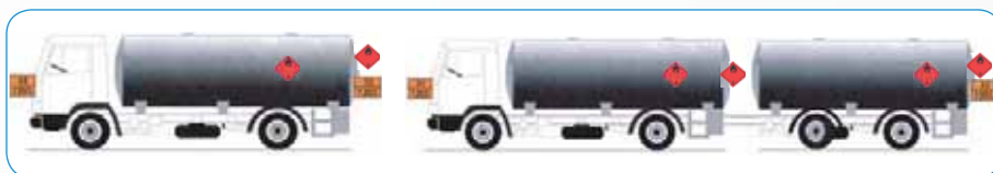
Rys. 6. Oznakowanie pojazdu-cysterny i jednostki transportowej przewożącej tylko UN 1203 lub przewożącej UN 1202 i UN 1203 w osobnych komorach cysterny lub osobnych cysternach
