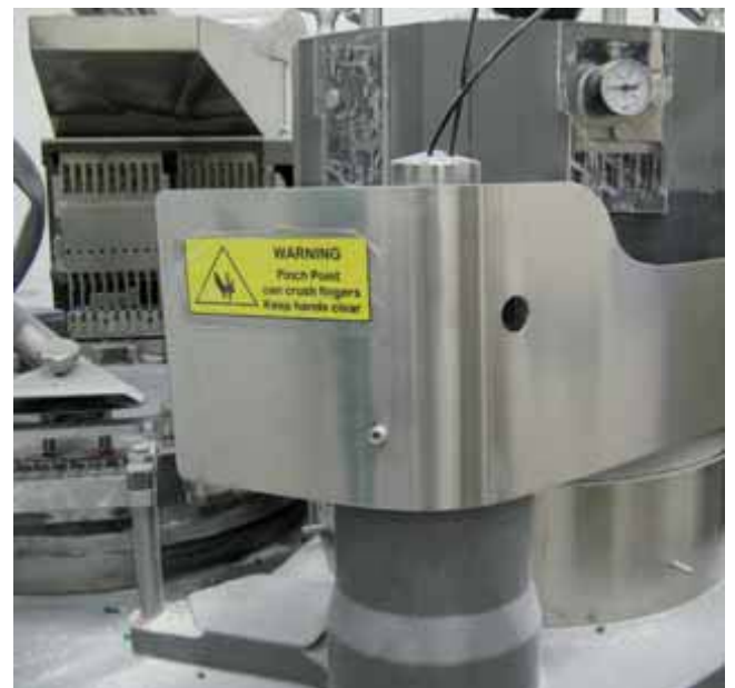
Nowe osłony chroniące ruchome części maszyny
