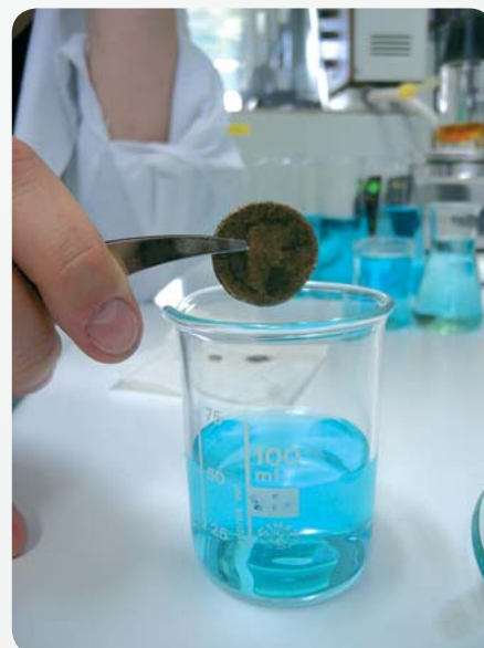
Fot. 1. Usuwanie nawarstwień tlenków z powierzchni brązowej monety w roztworze kwasu cytrynowego.
