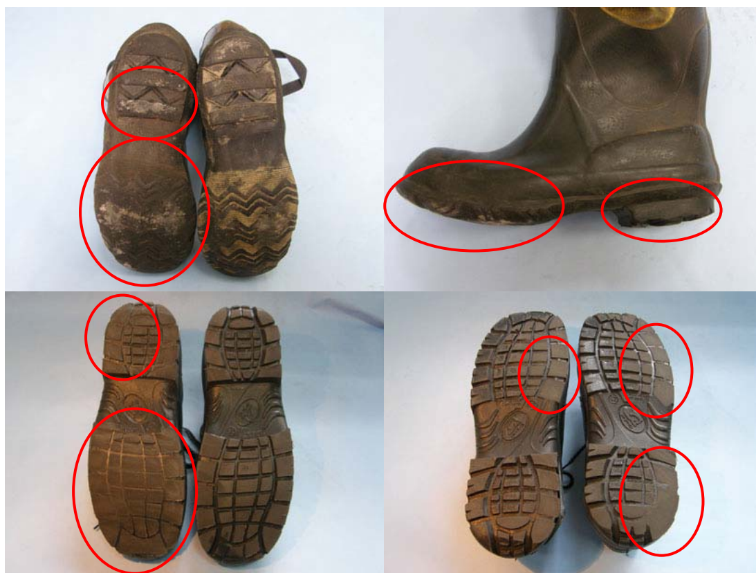
Rys. 7.1. Przykłady wytarcia materiałów podeszew i występów urzeźbienia w obuwiu
