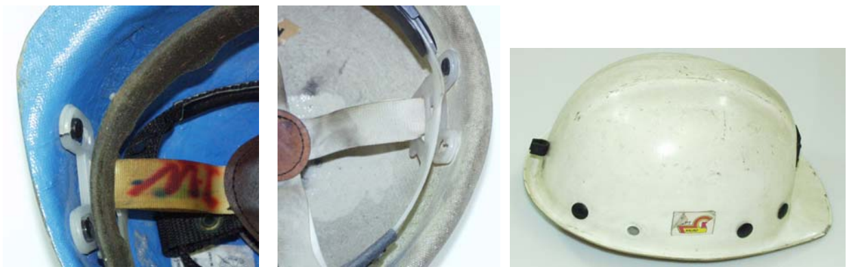
Rys. 2.10. Uszkodzenia zaczepów więźby
