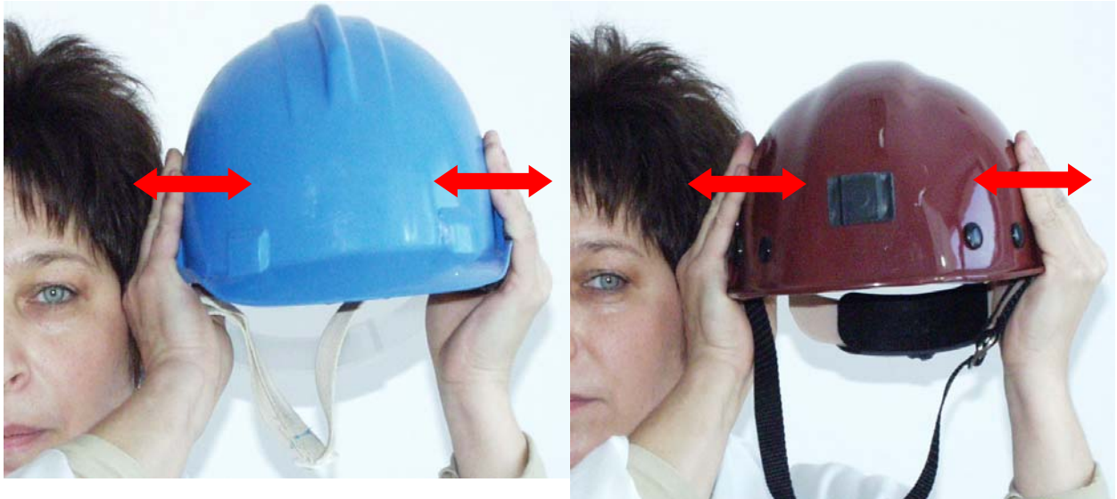
Rys. 2.1. Sprawdzanie trzeszczenia skorupy hełmu
