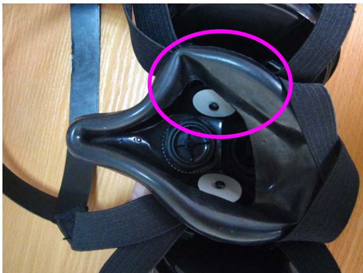
Rys. 5.18. Deformacja korpusu półmaski
