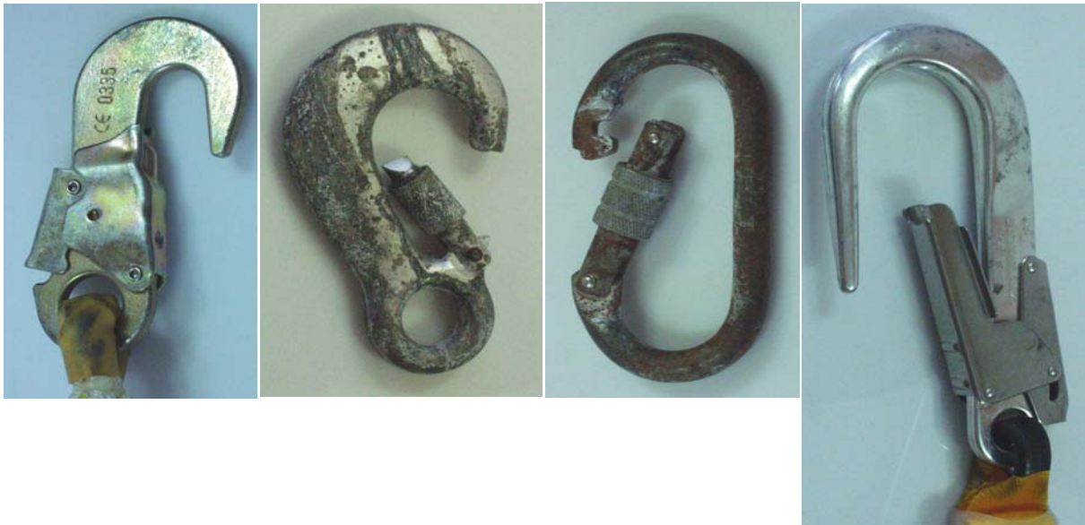
Rys. 3.5. Przykłady braku samoczynnego zamykania zatrzaśników
