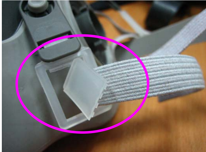
Rys. 5.19. Pęknięcie łącznika i elementu regulacji taśm nagłowa
