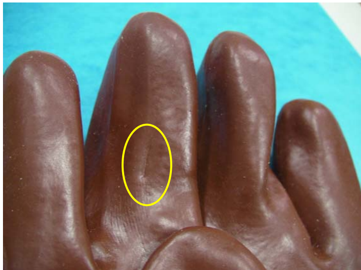
Rys. 6.17. Przykłady uszkodzeń mechanicznych rękawic chroniących przed czynnikami chemicznymi
