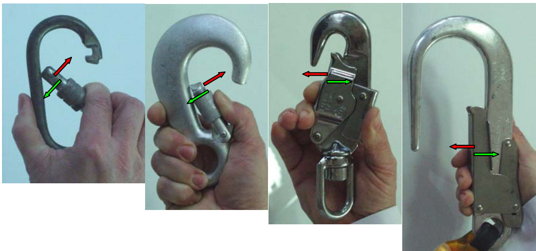
Rys. 3.4. Sprawdzenie samoczynnego zamykania się zatrzaśników
