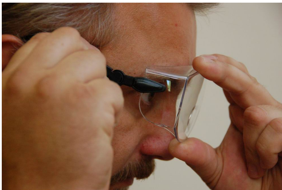
Rys. 4.10. Sprawdzenie zdolności utrzymania się okularów na głowie
