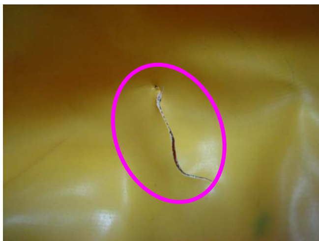
Rys. 5.25. Pęknięcie materiału kaptura
