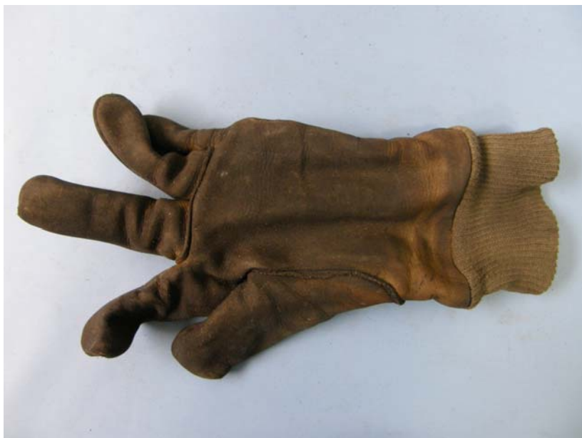
Rys. 6.6. Przykład usztywnienia materiału w skórzanej rękawicy
