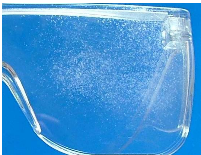
Rys. 4.2. Wzery powstałe w wyniku wtrąceń drobin obrabianego materiału
