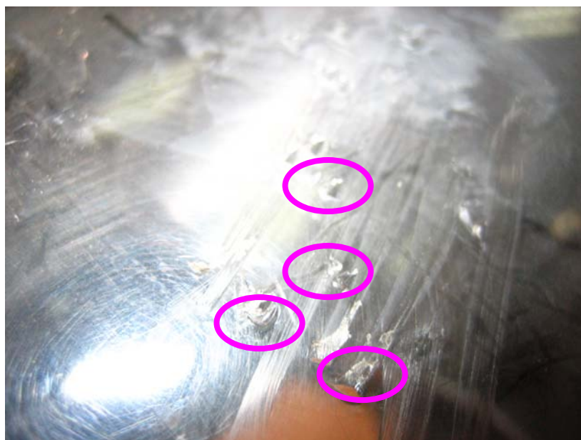
Rys. 5.9. Odpryski szyby wizjera maski
