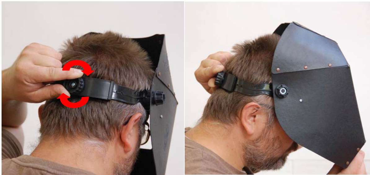
Rys. 4.25. Sprawdzanie regulacji nagłowia przyłbicy spawalniczej
