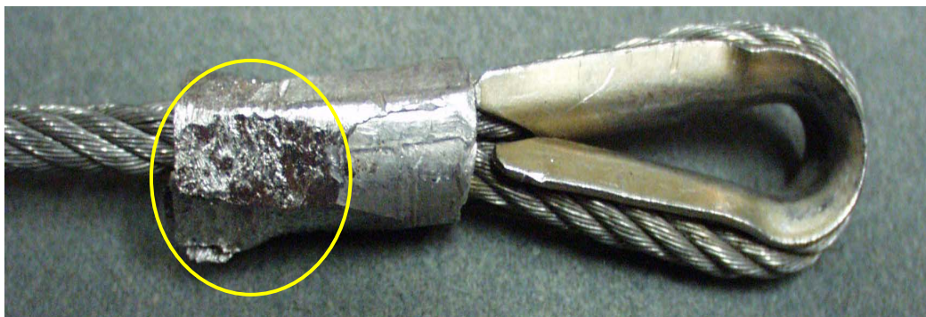
Rys. 3.19. Uszkodzenia tulei zaciskowej liny stalowej zaczeu linkowego
