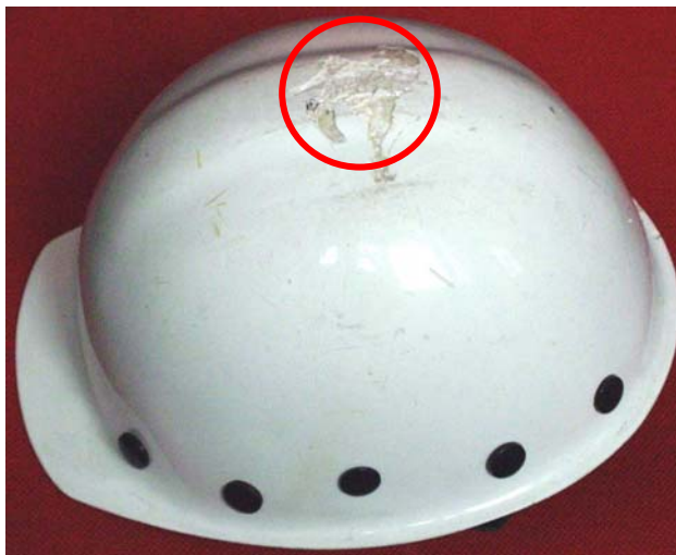
Rys. 2.6. Odpryski o dużej powierzchni materiału skorupy
