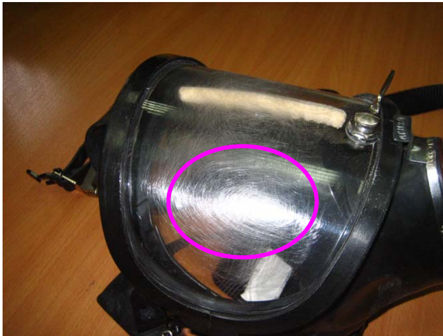
Rys. 5.10. Zmatowienie wizjera maski
