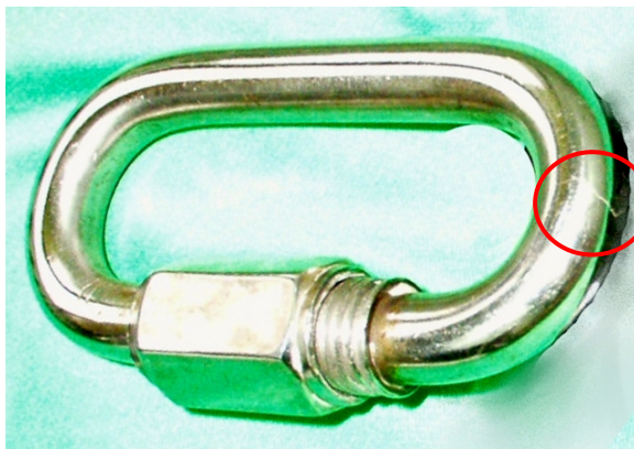
Rys. 3.12. Mikropęknięcie korpusu zatrzaśnika na skutek procesów korozyjnych
