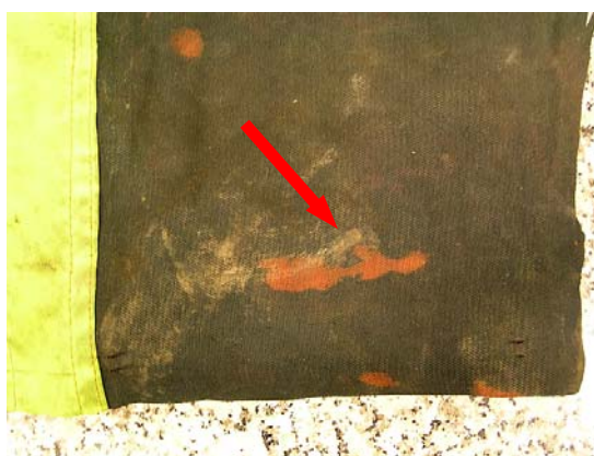
Rys. 8.3. Fragment odzieży ochronnej niepalnej z włókien aramidowych, którą należy wycofać z użytkowania z powodu zanieczyszczenia farbami
