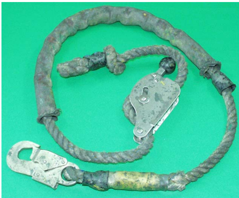
Rys. 3.30. Przykład silnego zabrudzenia farbami olejnymi linki do ustalania pozycji
