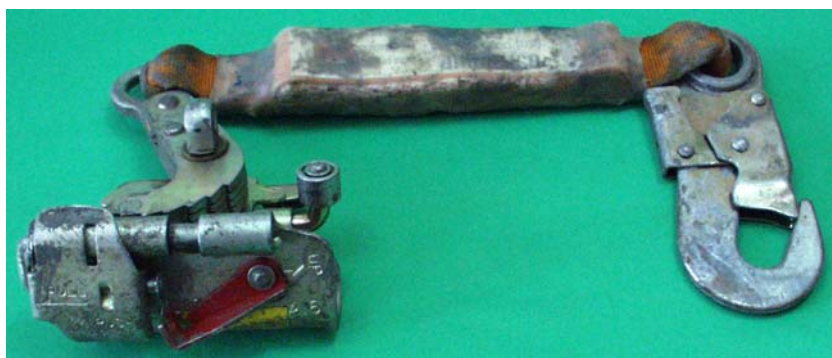
Rys. 3.52. Przykład silnego zabrudzenia mechanizmu i mikroamortyzatora urządzenia samozaciskowego
