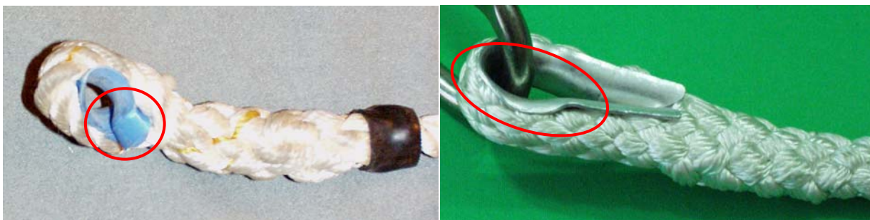
Rys. 3.25. Przykładowe uszkodzenia kausz w zakończeniach linek
