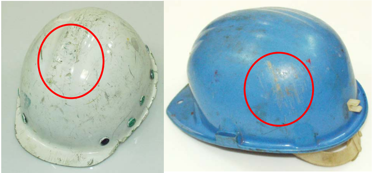
Rys. 2.5. Przebarwienia i głębokie obtarcia powierzchni skorupy hełmu
