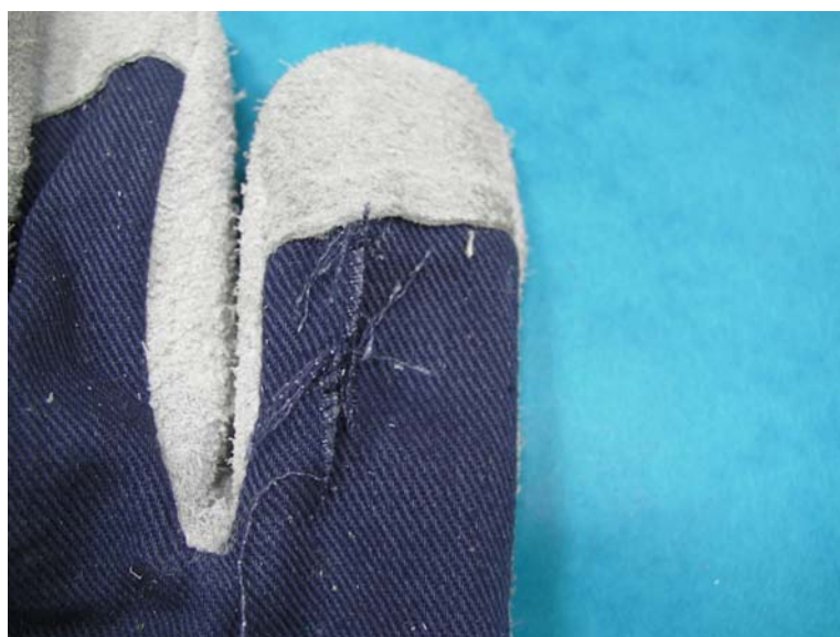
Rys. 6.12. Przykład przecięcia tkaniny rękawic chroniących przed czynnikami mechanicznymi
