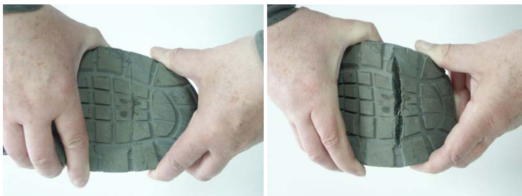
Rys. 7.3. Przykład badania podeszew obuwia pod kątem identyfikacji pęknięć i przecięć
