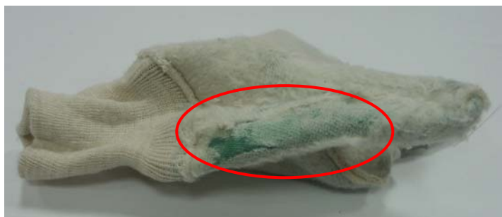
Rys. 6.18. Przykład uszkodzenia wyściółki rękawicy powlekanej
