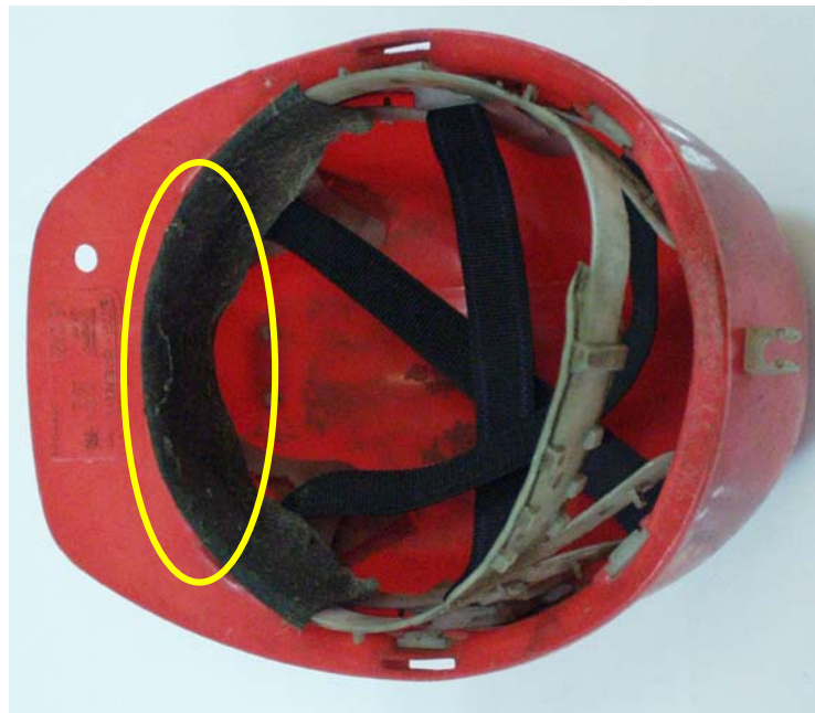
Rys. 2.16. Silne zabrudzenie potnika
