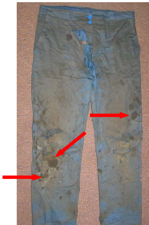
Rys. 8.2. Spodnie z bawełny impregnowanej przeciwpalnie, które należy wycofać z użytkowania z powodu zanieczyszczenia olejami
