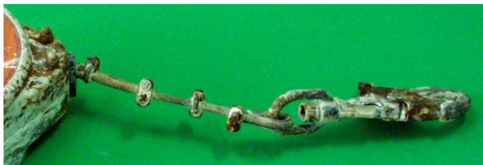
Rys. 3.44. Poprucie szwu zakończenia taśmy urządzenia samohamownego
