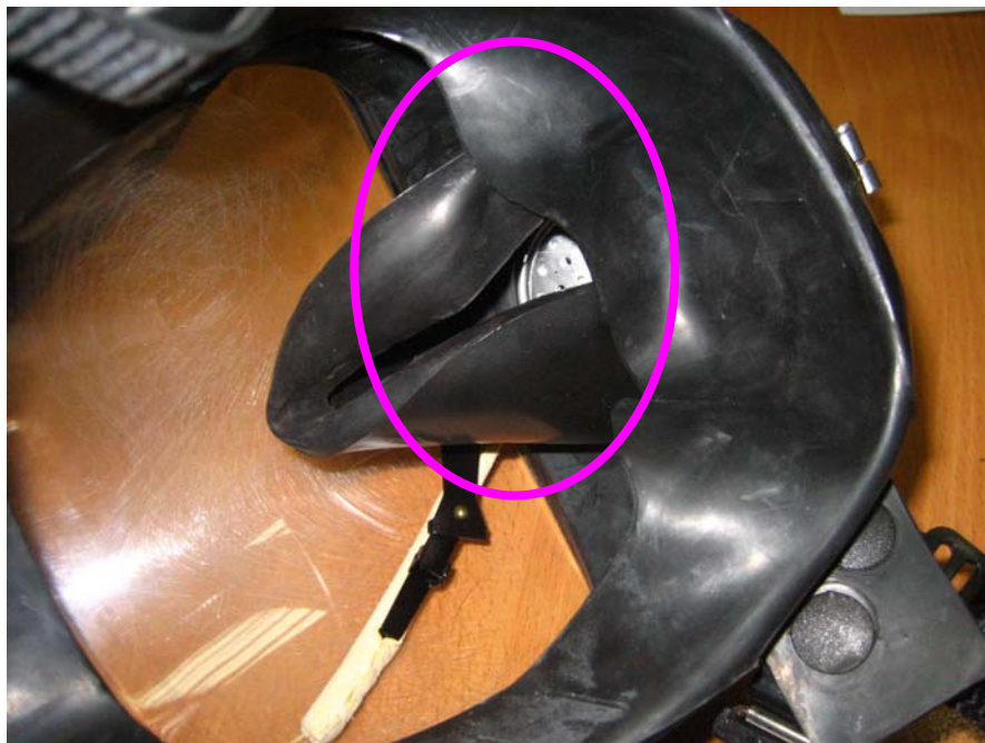
Rys. 5.3. Deformacja korpusu maski
