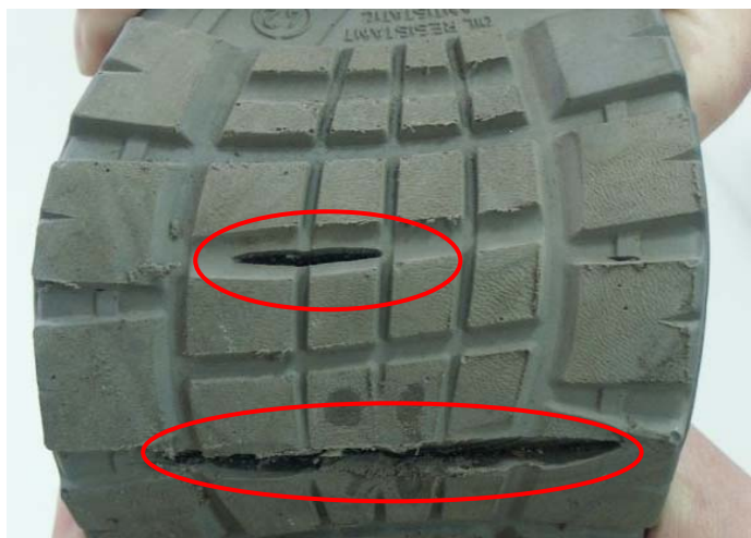
Rys. 7.4. Przykład przecięcia podeszwy
