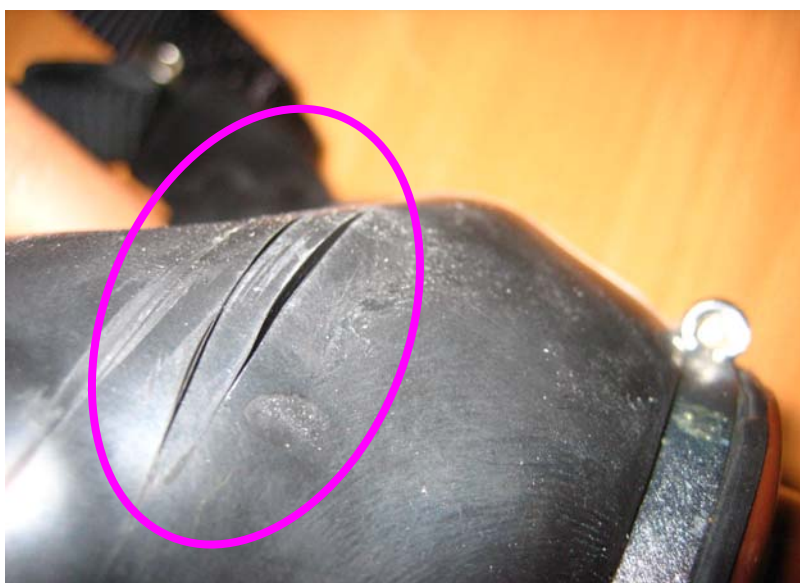
Rys. 5.1. Pęknięcia korpusu maski
