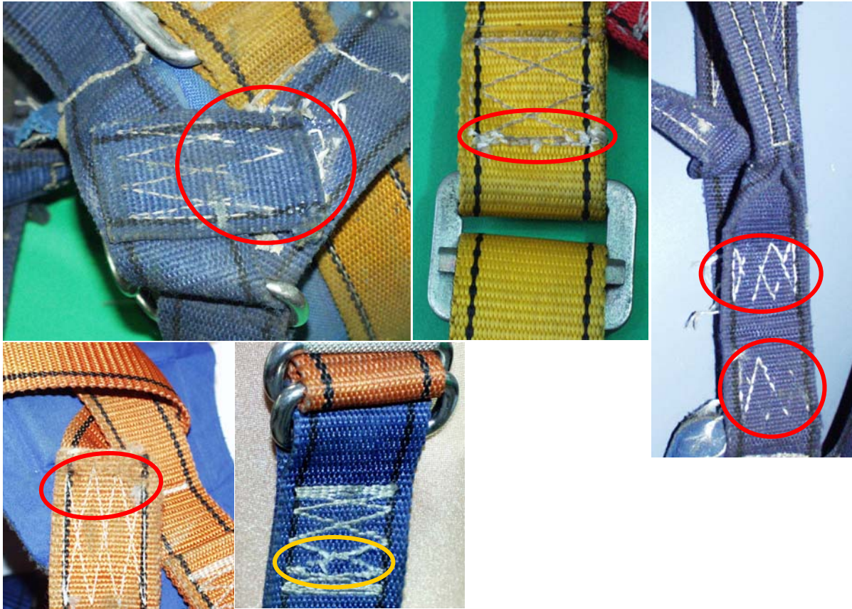
Rys. 3.61. Uszkodzenia szwów na taśmach włókienniczych
