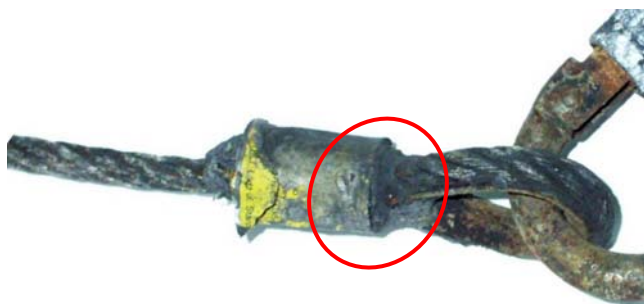
Rys. 3.26. Przykładowe uszkodzenie korozyjne zakończenia linki bezpieczeństwa (liny stalowej i kauszy)
