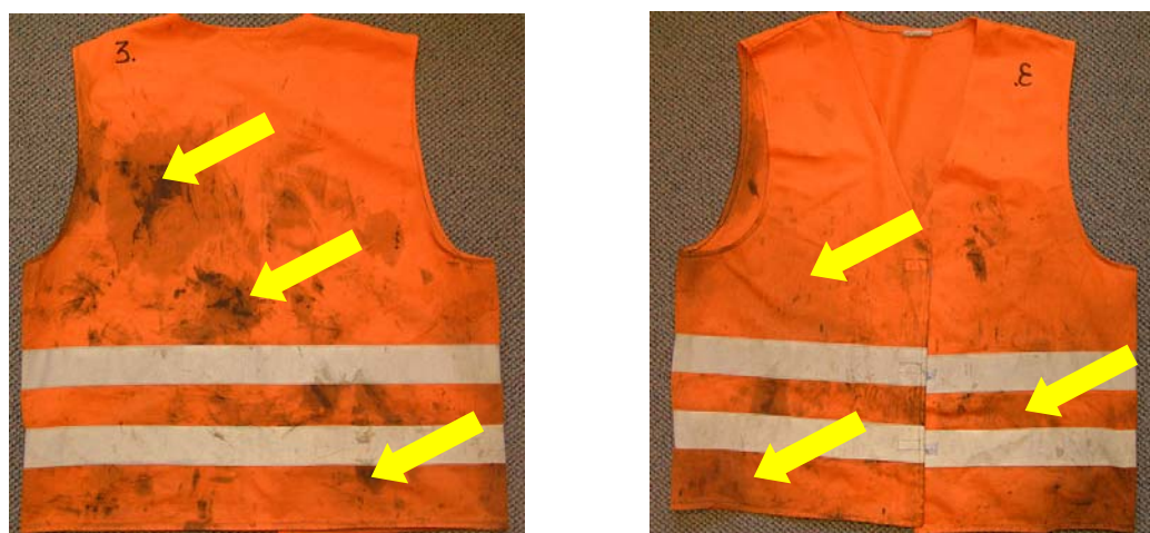
Rys. 8.16. Kamizelka ostrzegawcza po praniu, którą należy wycofać z użytkowania z powodu zabrudzeń substancjami ropopochodnymi
