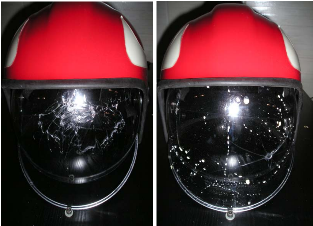
Rys. 4.15. Uszkodzenia osłony twarzy zamontowanej w helmie strażackim, powstałe na skutek działania agresywnych czynników chemicznych
