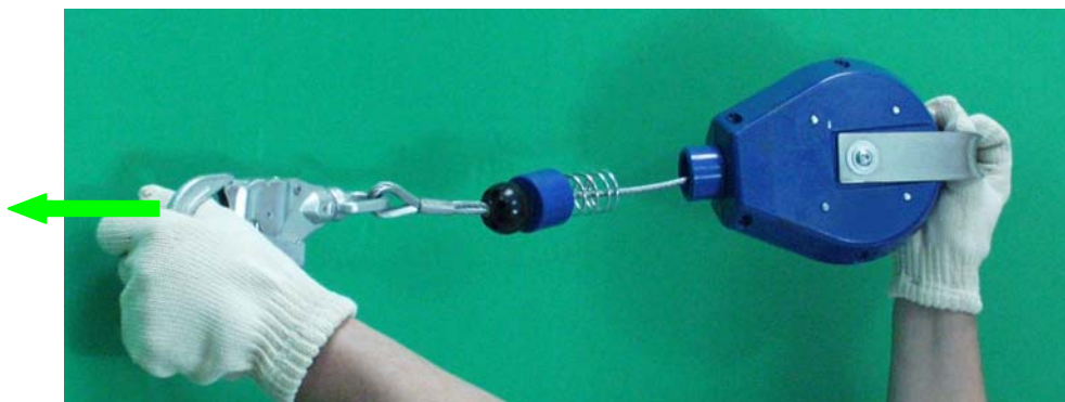
Rys. 3.40. Sprawdzenie poprawności działania blokady urządzenia samohamownego ← - kierunek gwałtownego szarpnięcia linki (taśmy) urządzenia
