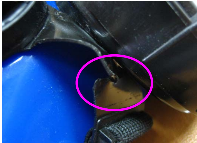
Rys. 5.20. Rozerwanie łącznika taśm nagłowa
