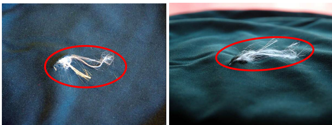
Rys. 8.13. Przykłady uszkodzeń (warstwy ochronnej) fragmentów odzieży chroniącej przed przecięciem piłą łańcuchową, kwalifikujących tę odzież do wycofania z użytkowania
