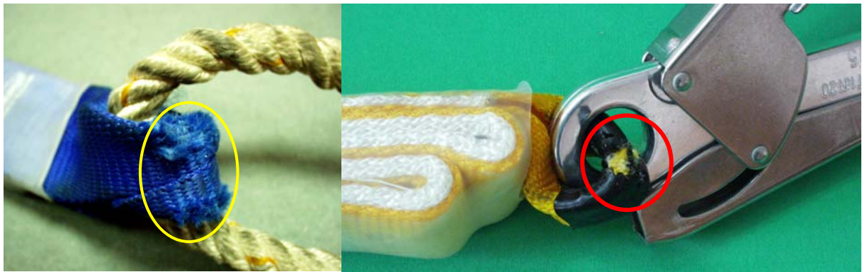
Rys. 3.36. Przetarcie taśmy nośnej amortyzatora i jej osłony
