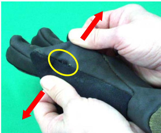
Rys. 6.1. Sprawdzenie trwałości szwów
