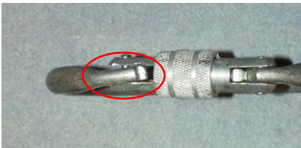
Rys. 3.8. Przykład deformacji korpusu i elementu ruchomego (ramienia) stalowego zatrzaśnika klasy B
