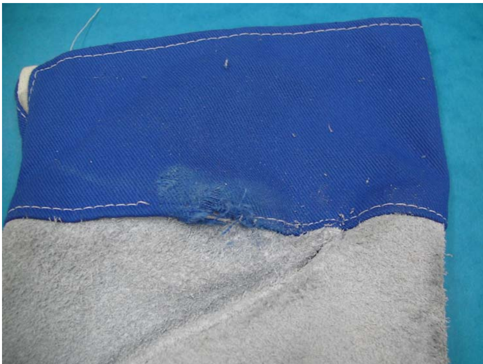
Rys. 6.14. Przykład przetarcia szwów w rękawicach skórzano-tekulinowych chroniących przed czynnikami mechanicznymi
