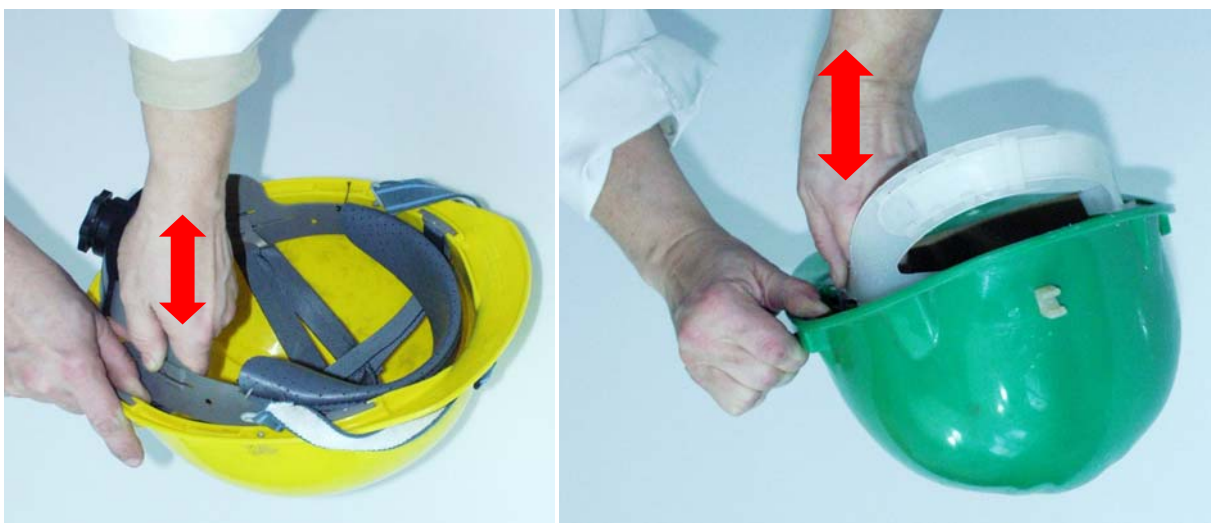
Rys. 2.13. Sprawdzanie połączenia pasa głównego ze skorupą hełmu
