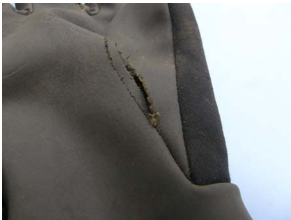
Rys. 6.2. Przykład uszkodzenia szwów rękawic częściowo powlekanych
