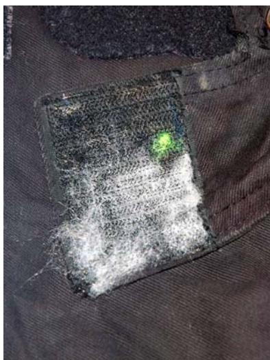
Rys. 8.6. Przykład zanieczyszczonego zapięcia na rzep w odzieży niepalnej
