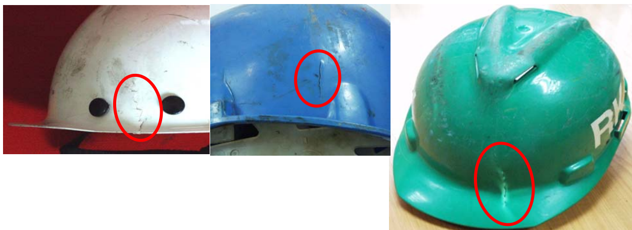
Rys. 2.2. Pęknięcia skorup hełmów
