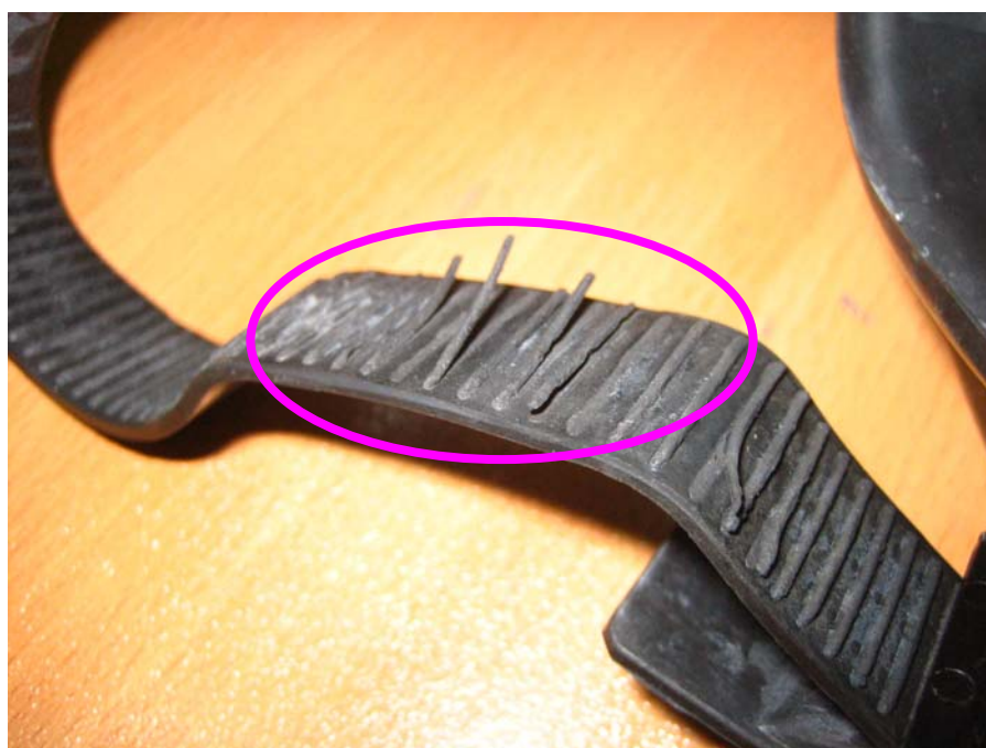
Rys. 5.5. Uszkodzenia taśmy nagłowia
