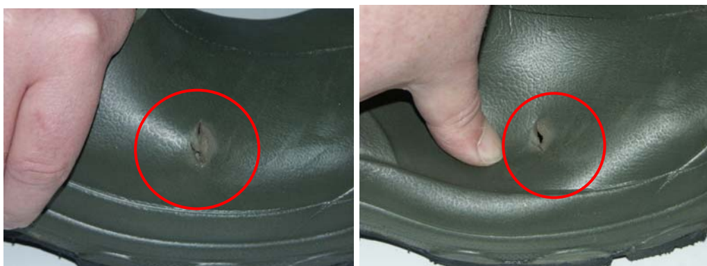
Rys. 7.8. Metoda sprawdzania uszkodzeń (przecięć) wierzchów obuwia
