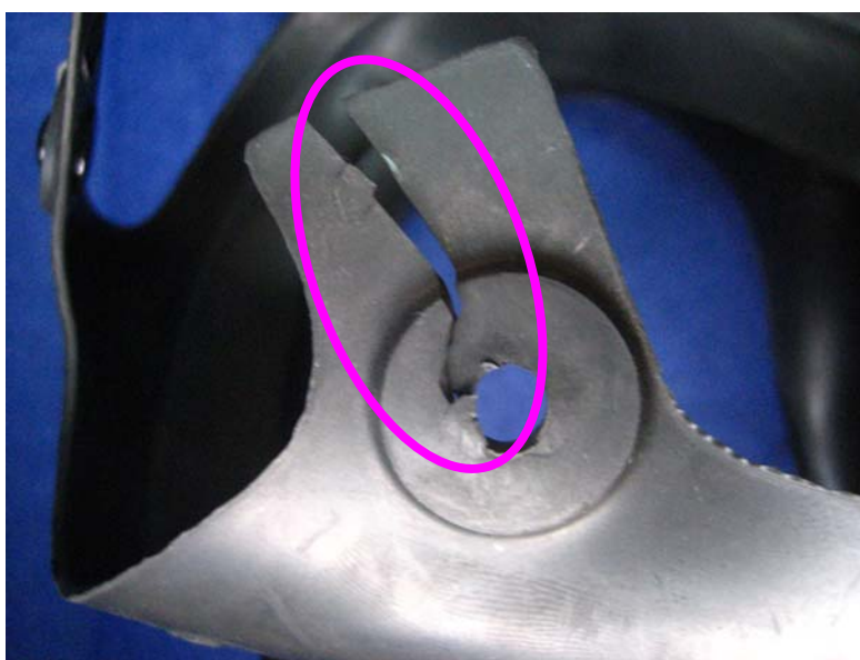
Rys. 5.7. Pęknięcie gniazda taśm nagłowia w korpusie maski
