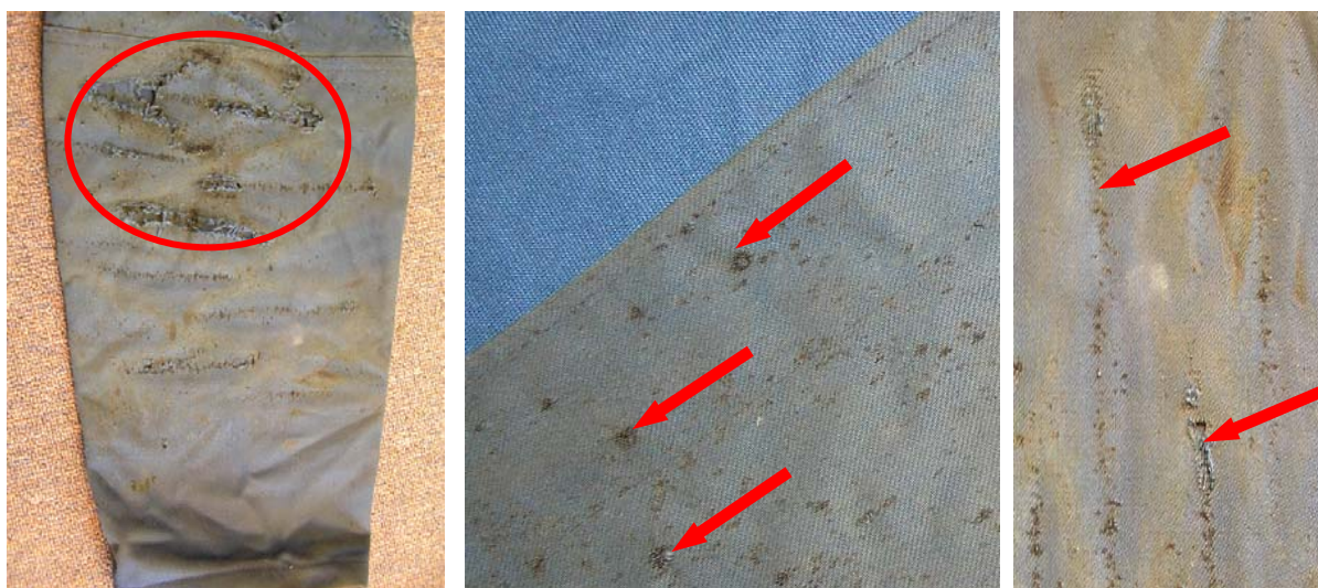
Rys. 8.1. Fragment odzieży ochronnej dla spawacza z dziurami wypalonymi przez krople stopionych metali
