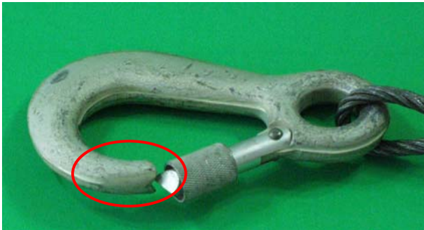
Rys. 3.7. Przykład deformacji korpusu aluminiowego zatrzaśnika klasy T
