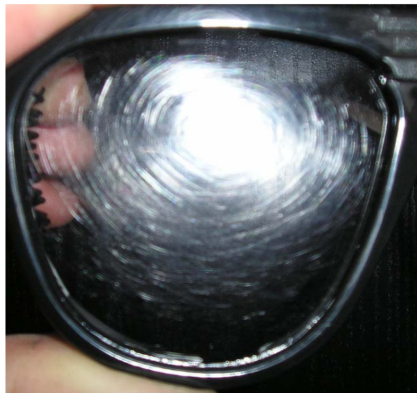
Rys. 4.6. Silne rozpraszanie światła na porysowanej szybce ochronnej znacznie utrudnia widzenie
