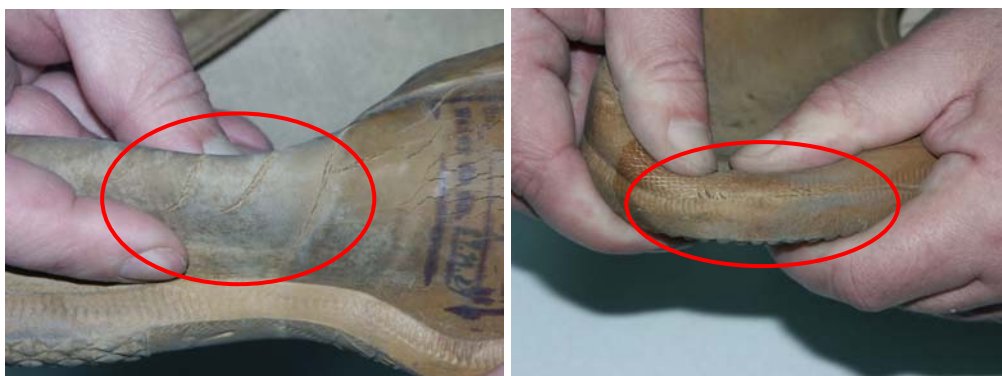
Rys. 7.7. Metoda sprawdzania uszkodzeń (pęknięć) wierzchów obuwia
