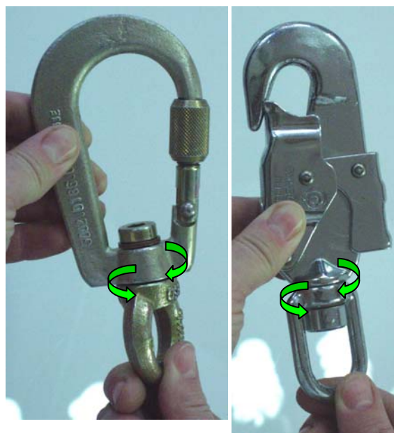
Rys. 3.6. Sprawdzanie działania elementów obrotowych zatrzaśników
