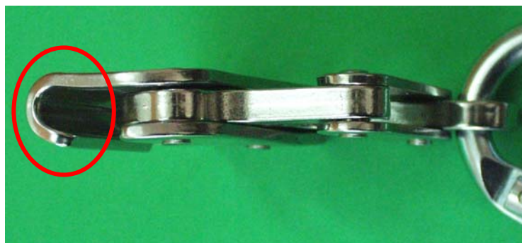
Rys. 3.49. Deformacja korpusu mechanizmu samozaciskowego
