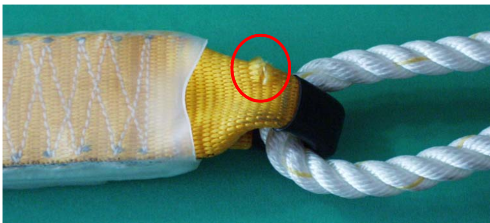
Rys. 3.37. Przecięcie taśmy nośnej amortyzatora
