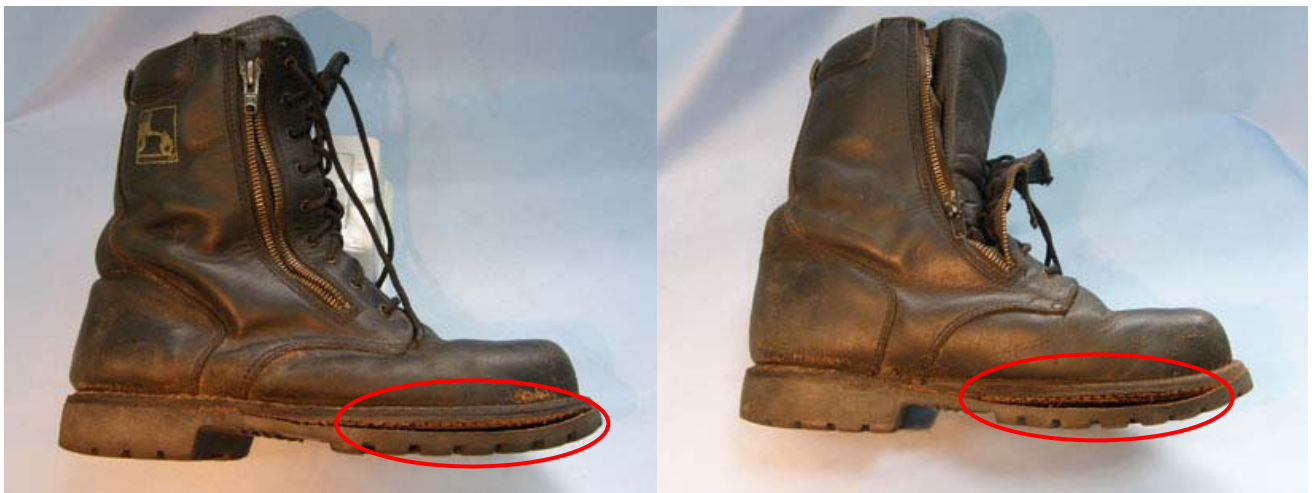
Rys. 7.6. Przykład rozwarstwienia podeszew wielowarstwowych w obuwiu skórzanym
