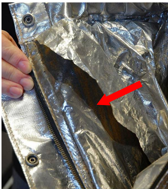
Rys. 8.11. Uszkodzenie materiału zewnętrznego odzieży z tkaniny aluminiowanej zlokalizowane przy zapięciu
