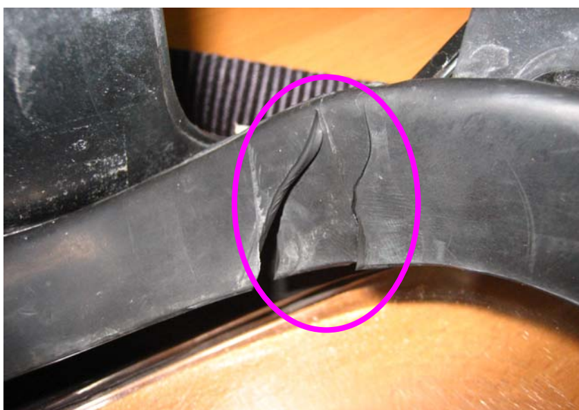
Rys. 5.2. Wyszczerbienia uszczelnienia maski
