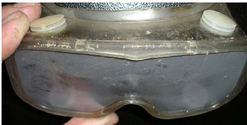
Rys. 4.12. Przykład zmatowienia i porysowana szybki ochronnej i oprawy gogli
