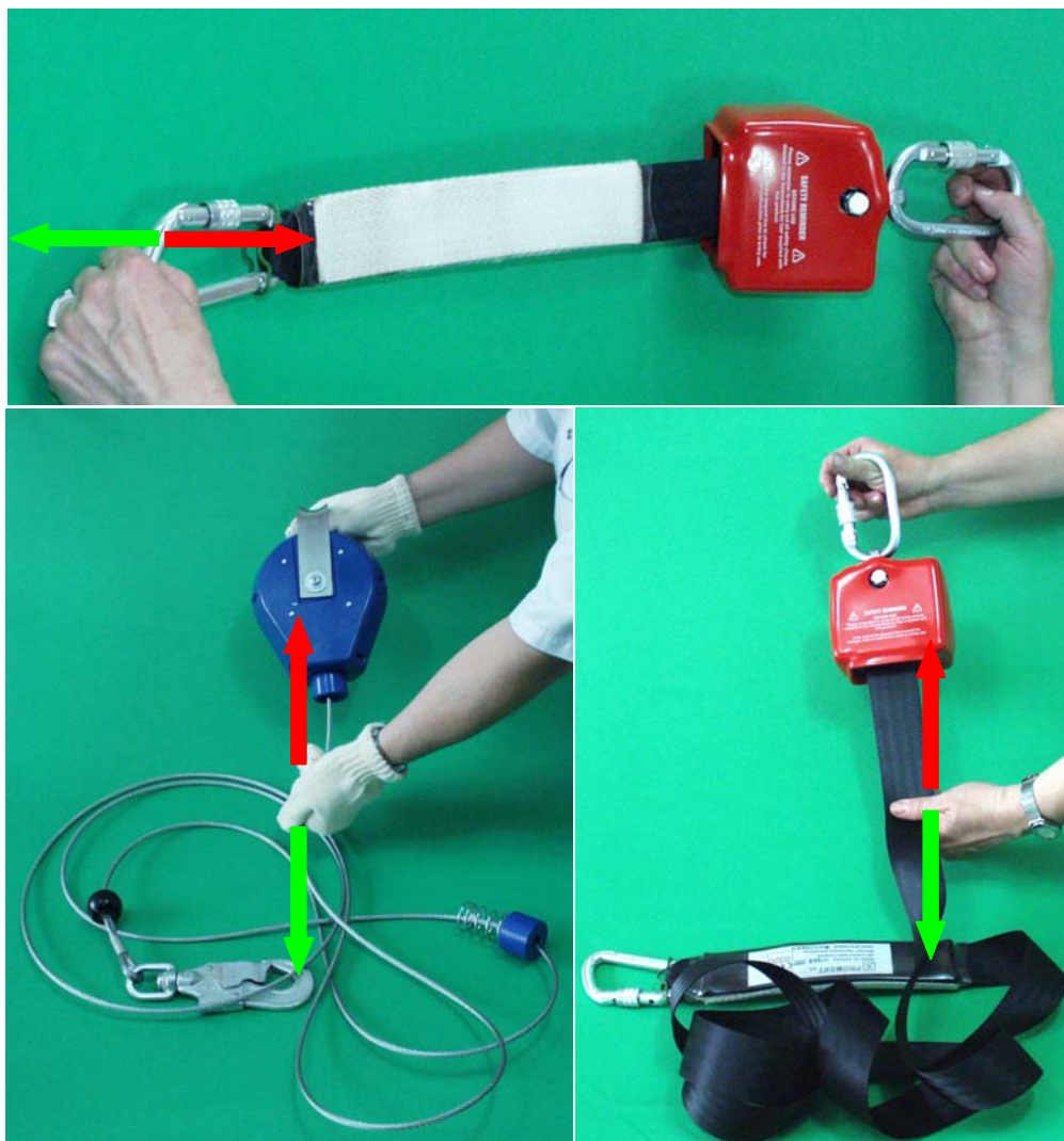
Rys. 3.39. Sprawdzanie poprawności działania urządzenia samohamownego
