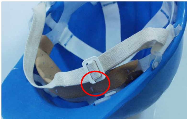
Rys. 2.20. Uszkodzenia klamerki regulacyjnej paska podbródkowego
