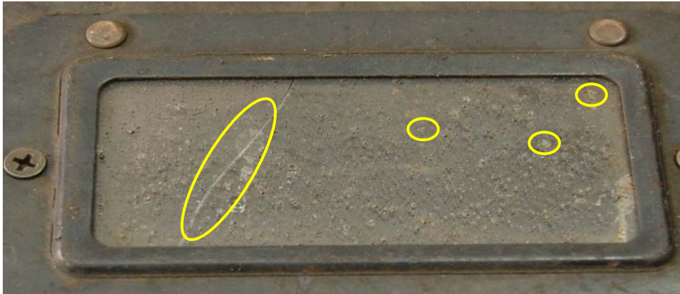
Rys. 4.20. Pęknięty filtr spawalniczy z wtopionymi odpryskami stopionego metalu
