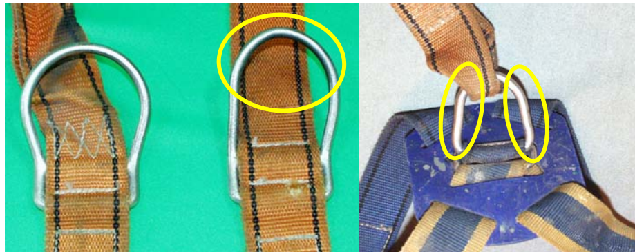
Rys. 3.64. Deformacje klamer zaczepowych pasa do ustalania pozycji i szelek bezpieczeństwa
