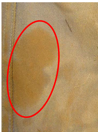
Rys. 8.9. Fragment odzieży ochronnej zanieczyszczony olejami, którą należy wycofać z użytkowania i poddać konserwacji poprzez szamponowanie
