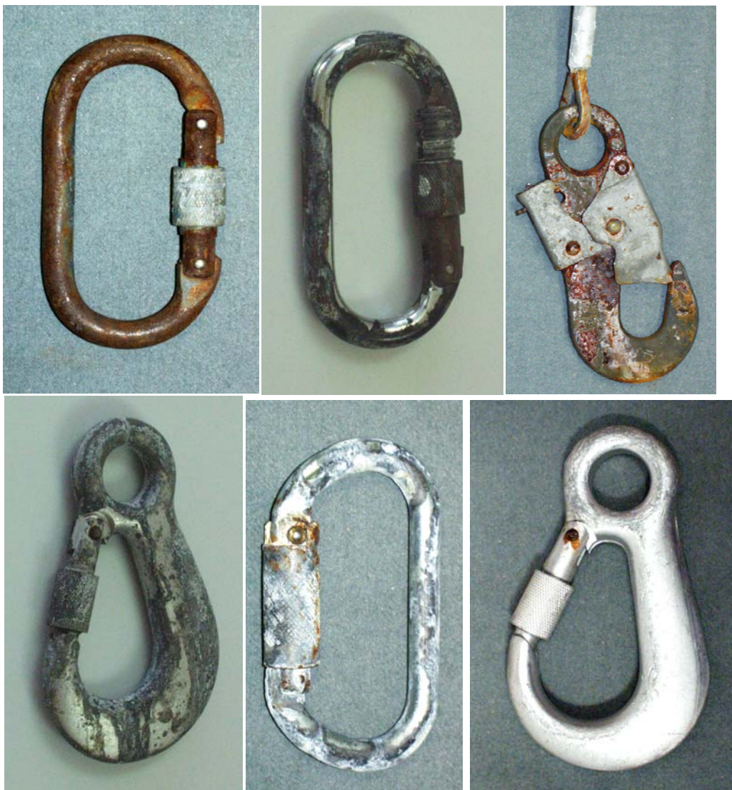
Rys. 3.10. Przykłady korozji elementów zatrzaśników klasy B i T
