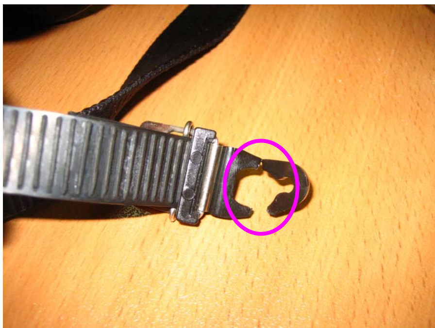
Rys. 5.4. Pęknięcie łącznika taśmy nagłowia
