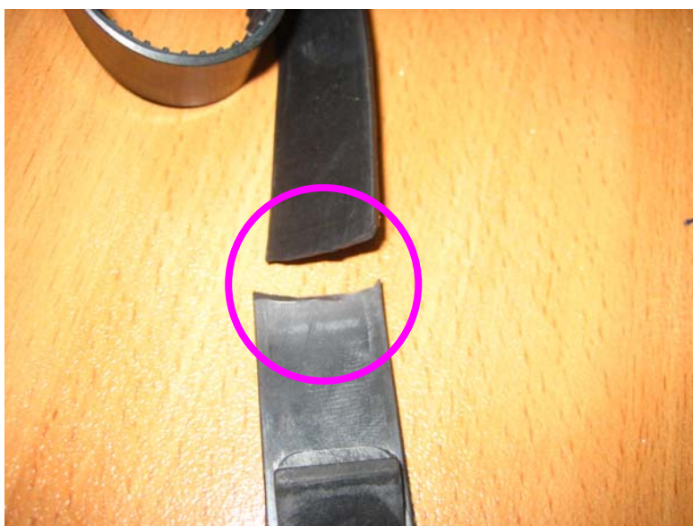
Rys. 5.6. Pęknięcie taśmy nagłowia maski
