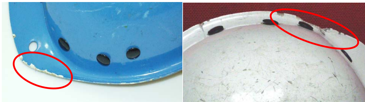
Rys. 2.7. Poszczerbienia brzegu skorupy
