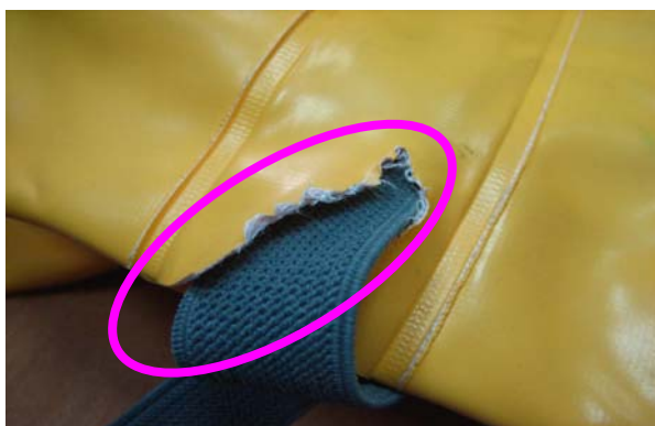
Rys. 5.29. Rozerwanie tunelu taśm nagłowia kaptura
