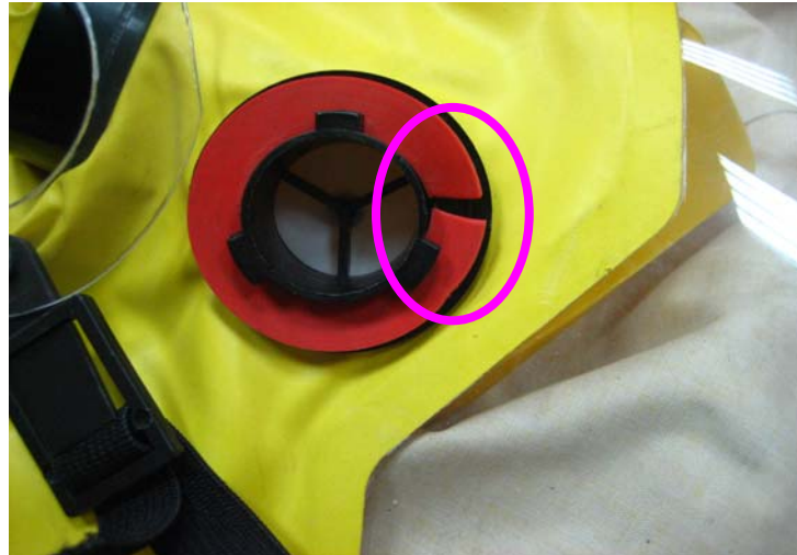
Rys. 5.34. Uszkodzenie uszczelki łącznika bagnetowego kaptura
