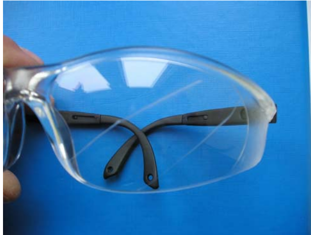
Rys. 4.4. Pojedyncze rysy na szybce ochronnej znajdujące się w polu widzenia
