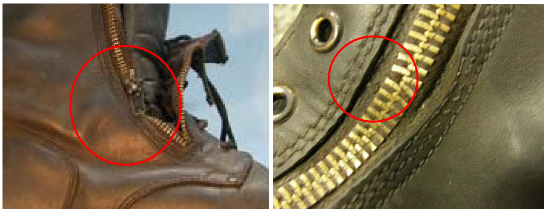
Rys. 7.13. Przykłady uszkodzeń zamka błyskawicznego zapewniającego dopasowanie obuwia
