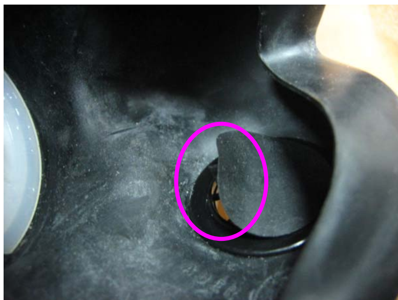
Rys. 5.12. Zniekształcenie płatka zaworu wdechowego półmaski wewnętrznej maski
