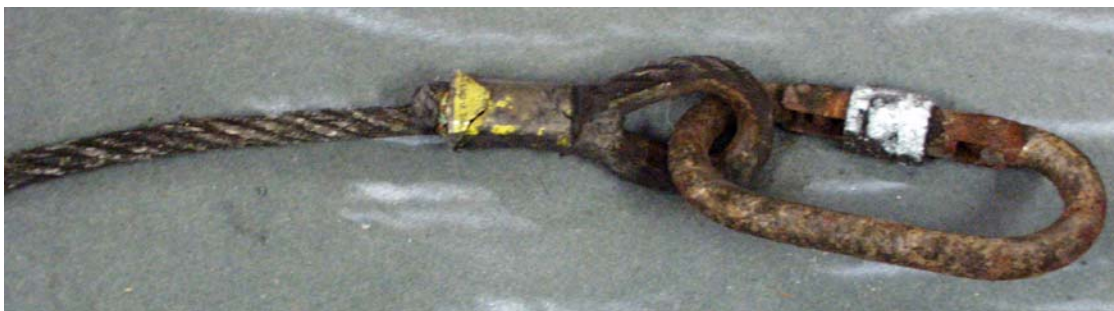
Rys. 3.20. Uszkodzenia korozyjne zaczeu kotwiczącego
