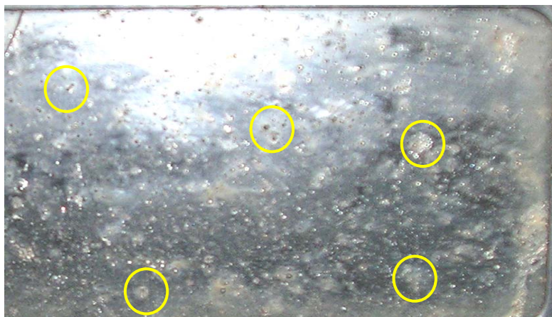
Rys. 4.21. Powierzchnia filtra spawalniczego ze zmatowieniami, wżerami i wtopionymi odpryskami stopionego metalu
