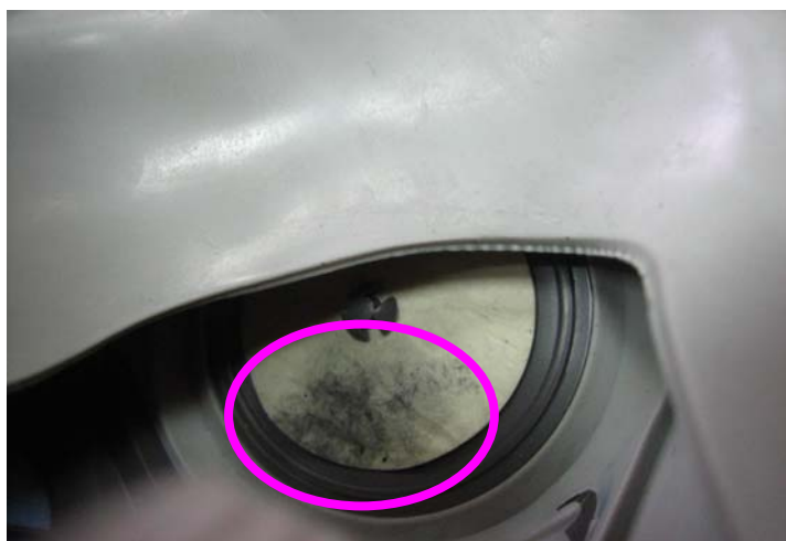
Rys. 5.22. Silne zabrudzenie zaworu półmaski
