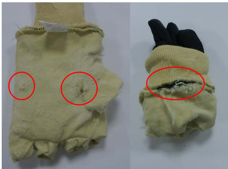
Rys. 6.19. Przykład uszkodzenia wyściółek rękawic skórzano-tkaninowych
