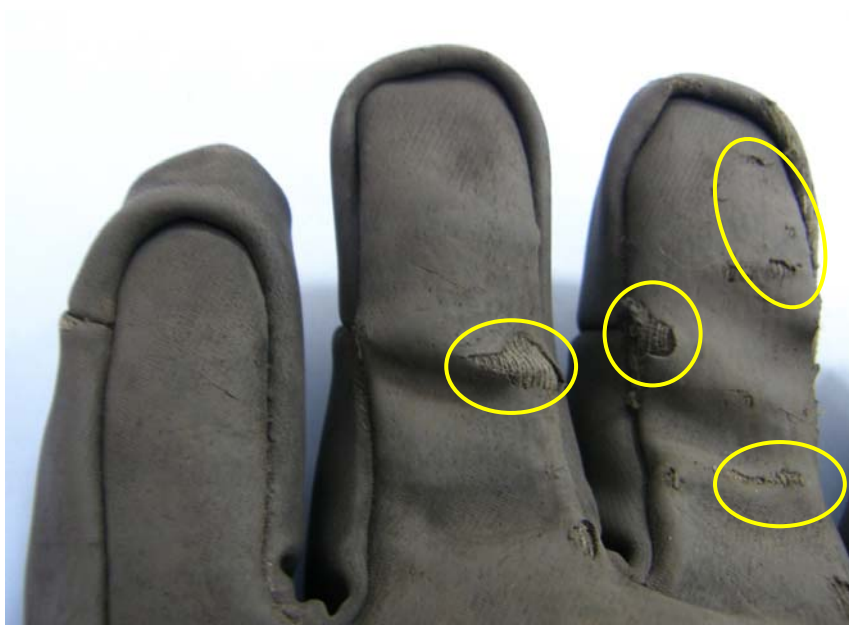
Rys. 6.3. Przykład uszkodzenia powleczeń rękawic częściowo powlekanych
