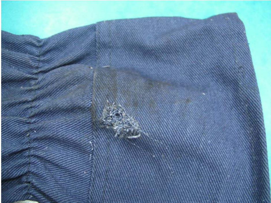
Rys. 6.13. Przykład przetarcia tkaniny rękawic chroniących przed czynnikami mechanicznymi
