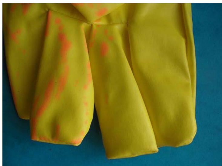
Rys. 6.16. Przykład zmian materiałowych w postaci przebarwień w rękawicach chroniących przed czynnikami chemicznymi
