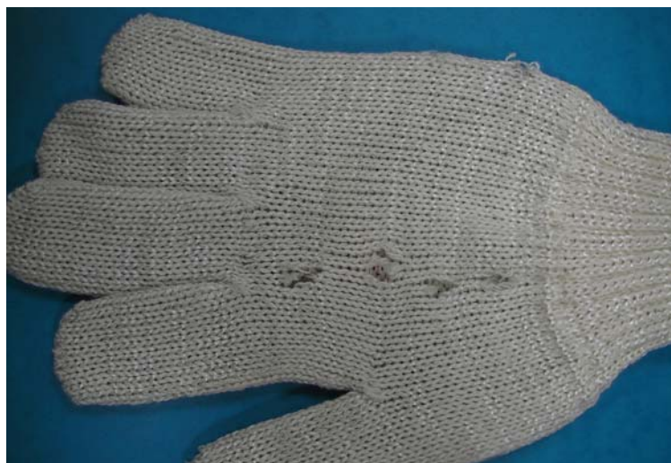
Rys. 6.11. Przykłady uszkodzenia mechanicznego rękawic wykonanych z włókien aramidowych
