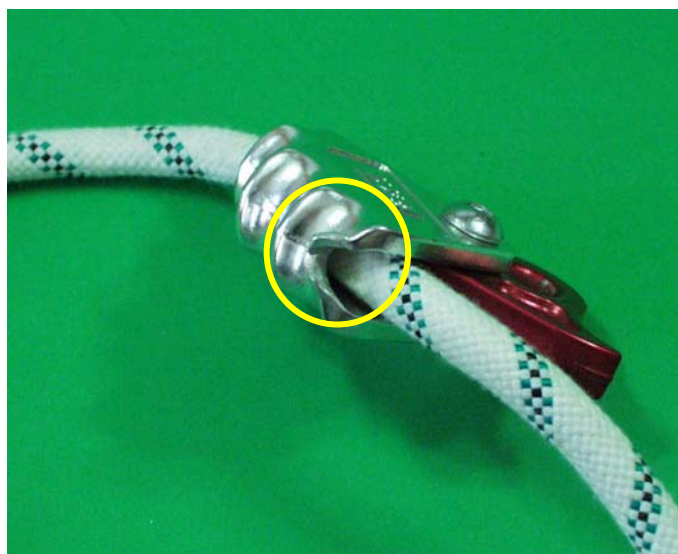
Rys. 3.34. Przykład uszkodzenia regulatora długości linki do ustalania pozycji
