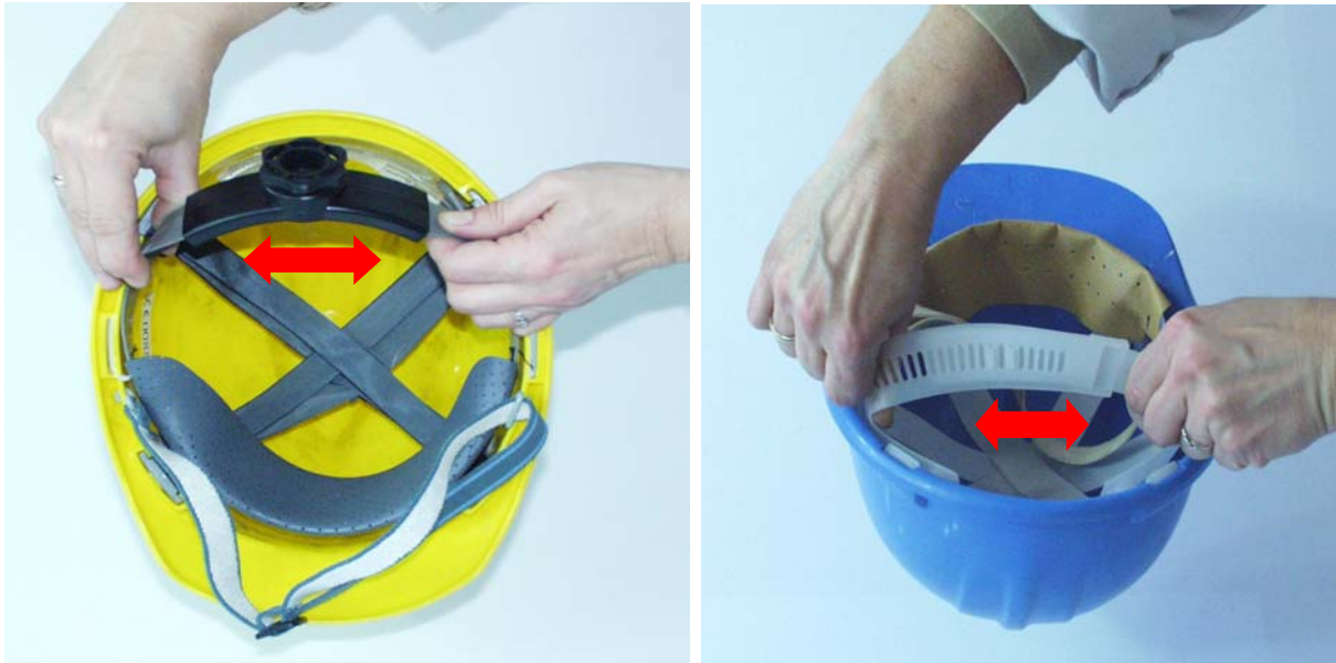
Rys. 2.14. Sprawdzanie trwałości ustawienia długości pasa głównego
