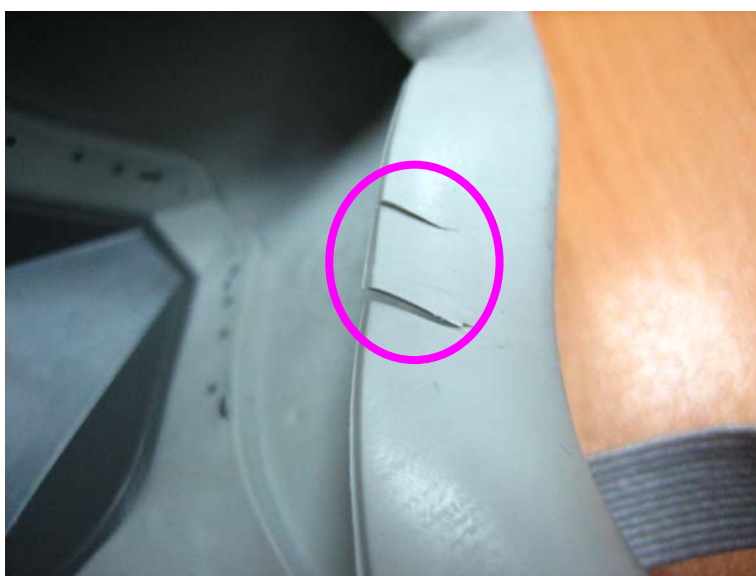
Rys. 5.17. Pęknięcia i wyszczerbienia uszczelnienia półmaski
