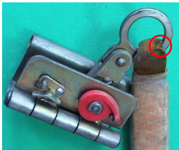
Rys. 3.50. Przecięcie taśmy włókienniczej mikroamortyzatora urządzenia samozaciskowego
