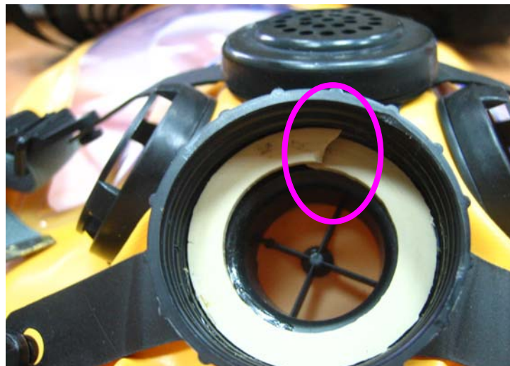
Rys. 5.35. Uszkodzenie uszczelki łącznika gwintowego kaptura
