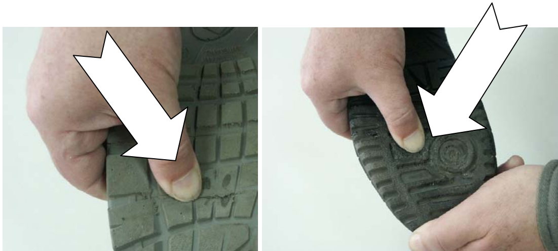
Rys. 7. 2. Przykład sprawdzania grubości materiałów podeszew przez wgniatanie ich kciukiem
