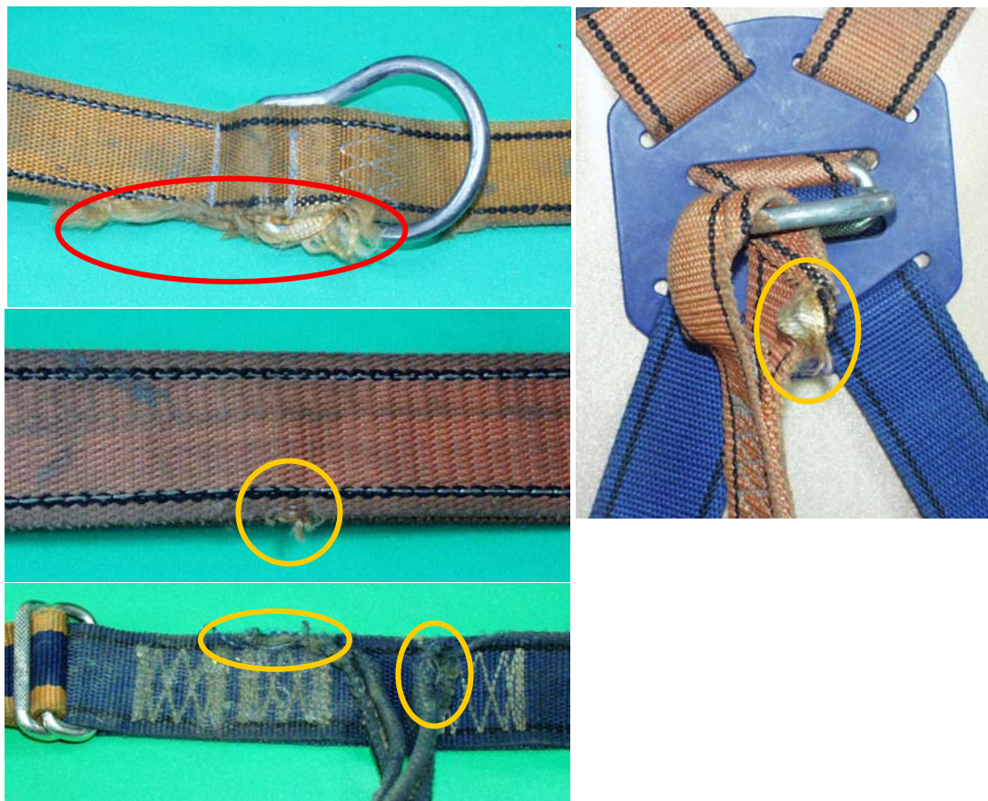
Rys. 3.58. Przetarcia brzegów taśm włókienniczych
