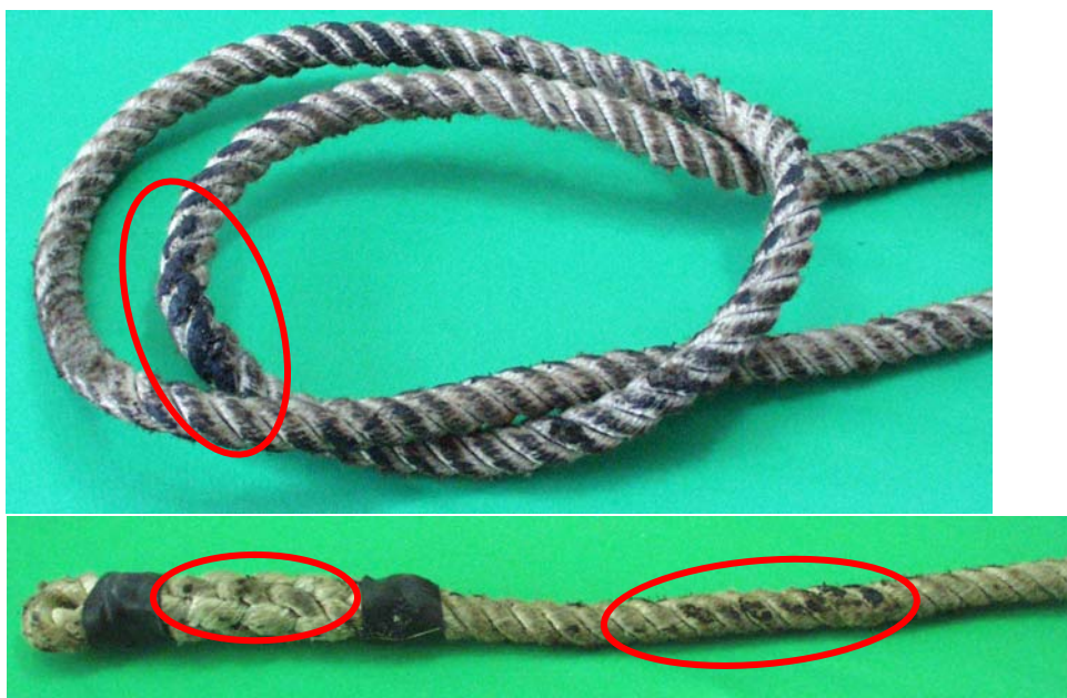
Rys. 3.51. Przykłady silnego zabrudzenia przewodnicy urządzenia samozaciskowego
