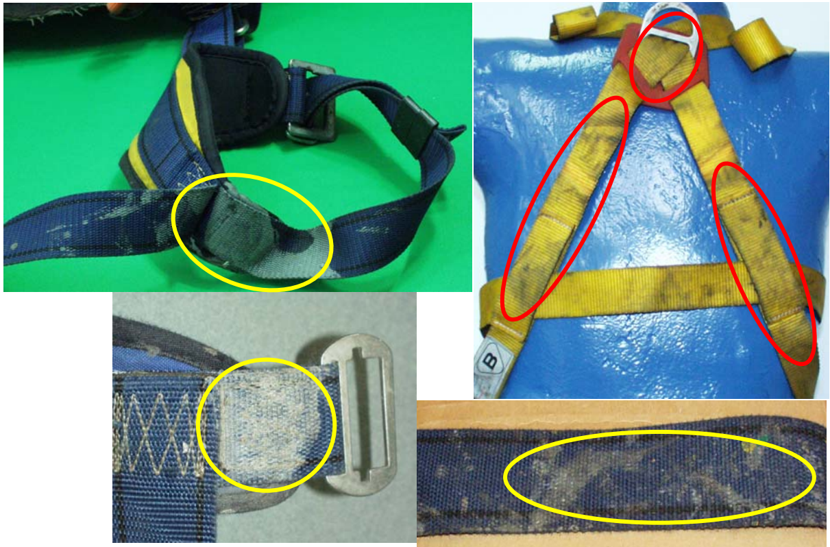
Rys. 3.63. Silne zabrudzenia taśm włókienniczych
