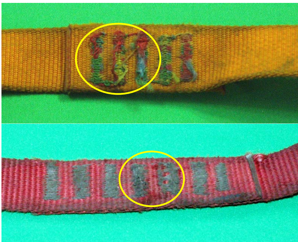
Rys. 3.16. Uszkodzenia szwów zaczepów taśmowych
