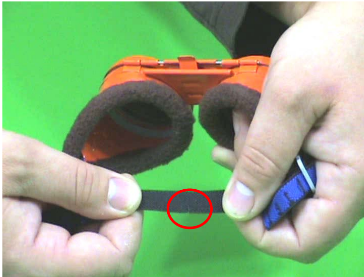
Rys. 4.29. Sprawdzanie stanu taśmy opasującej głowę
