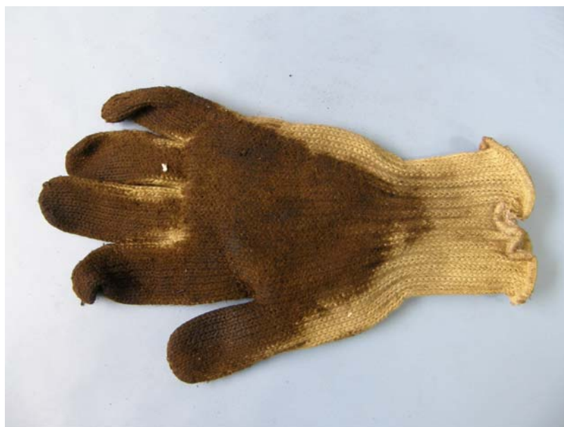
Rys. 6.8. Rękawice z włókien aramidowych zabrudzone substancjami olejowymi
