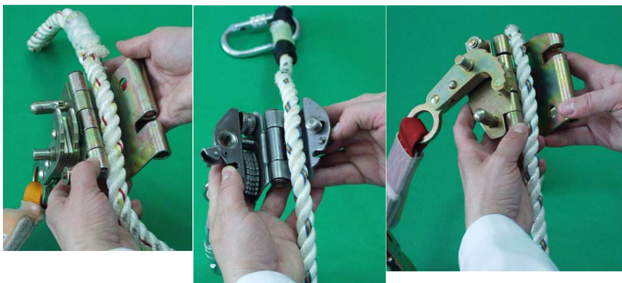
Rys. 3.48. Przykłady odblokowanych i otwartych mechanizmów samozaciskowych
