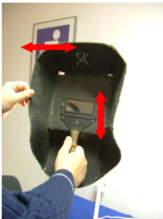
Rys. 4.22. Sprawdzenie stabilności mocowania filtra i szybki ochronnej
