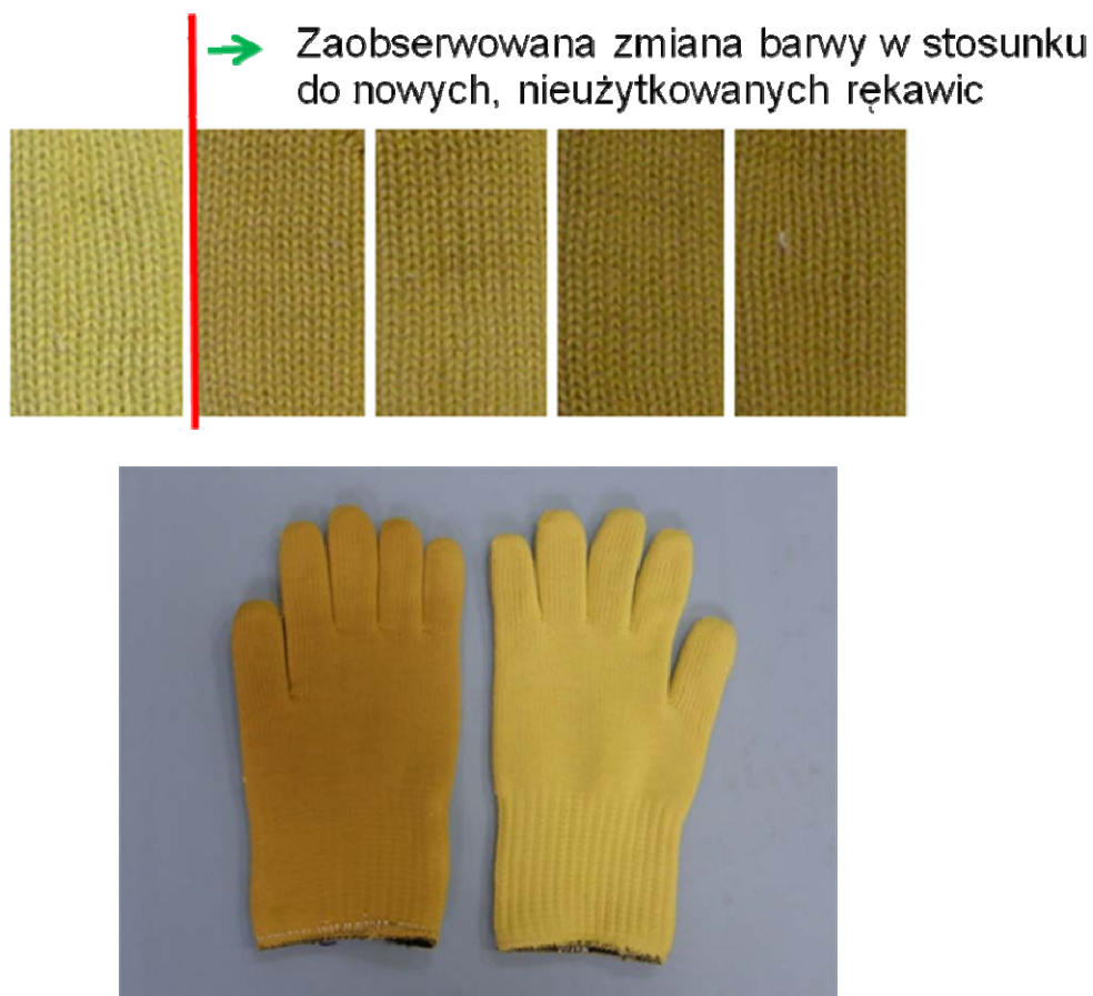
Rys. 6.7. Przykład przebarwień rękawic wykonanych z włókien aramidowych
