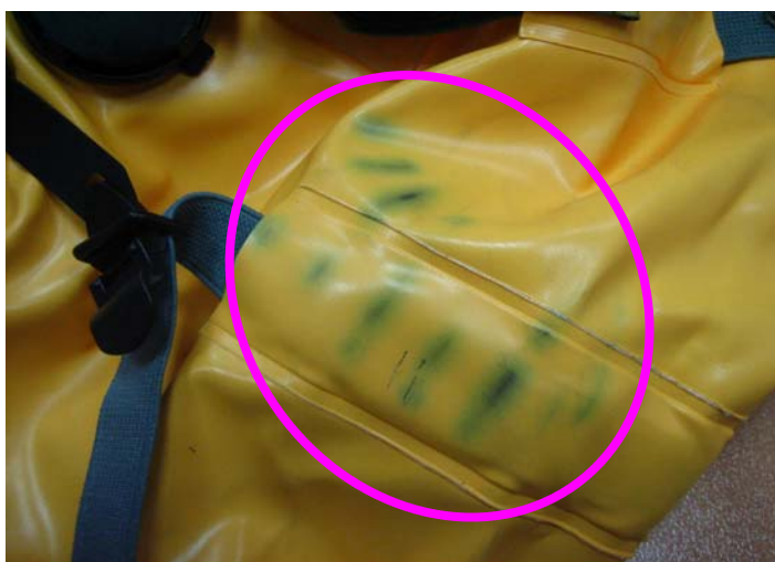
Rys. 5.27. Przebarwienia materiału kaptura
