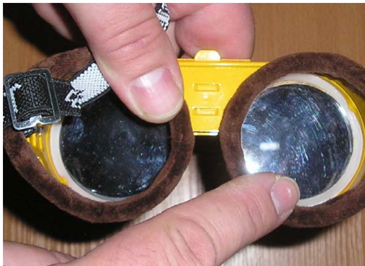
Rys. 4.30. Sprawdzanie stanu poduszek ochronnych
