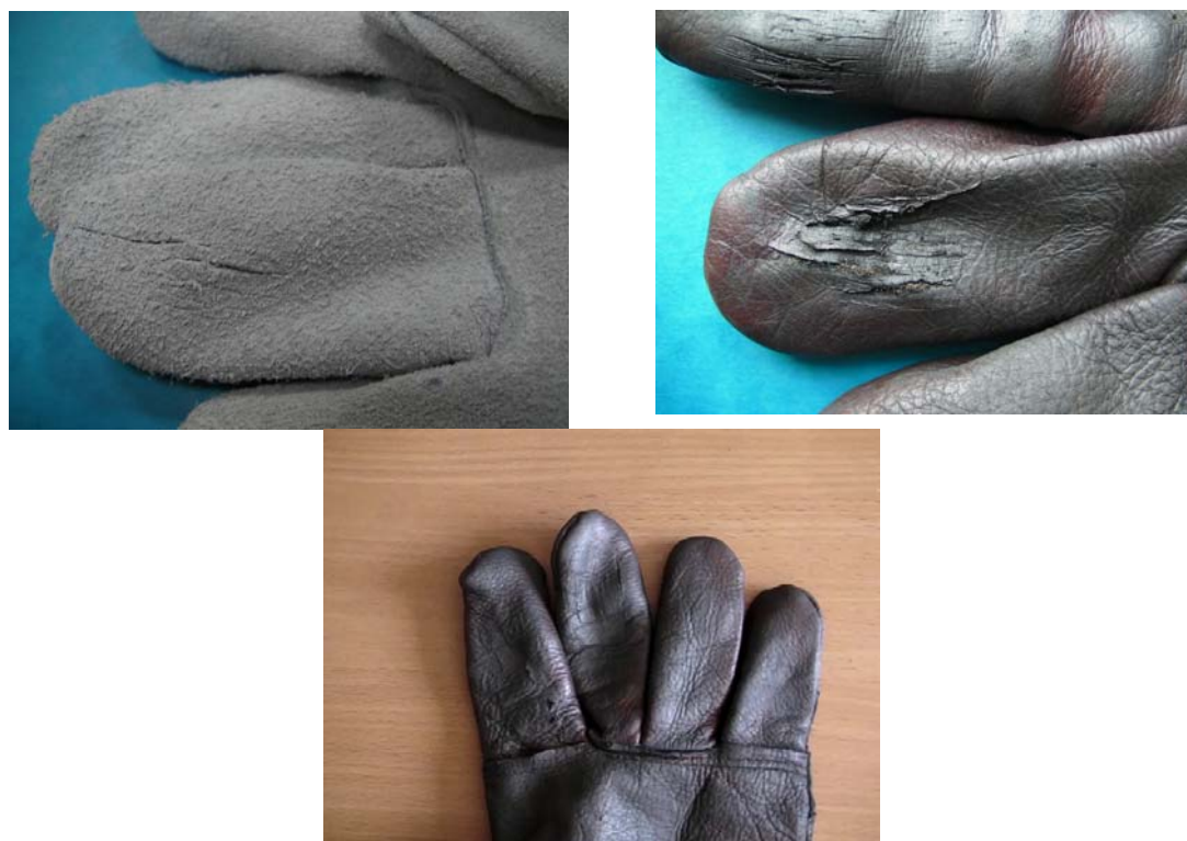
Rys. 6.10. Przykłady uszkodzenia rękawic skórzanych w wyniku przecięcia skóry
