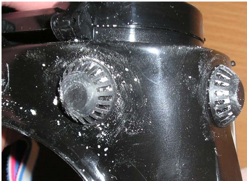
Rys. 4.17. Niedrożne (zapchane) otwory wentylacyjne w goglach
