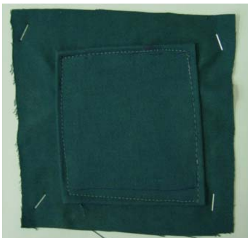
Rys. 8.8. Prawidłowo naprawiony fragment odzieży
