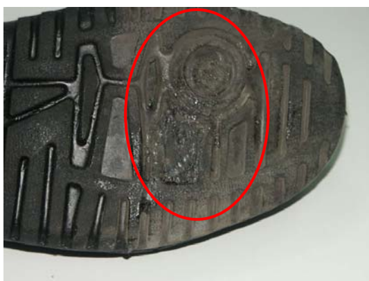
Rys. 7.5. Przykład uszkodzeń termicznych podeszwy obuwia
