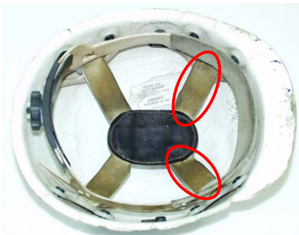
Rys. 2.11. Silne zabrudzenia taśm więźby
