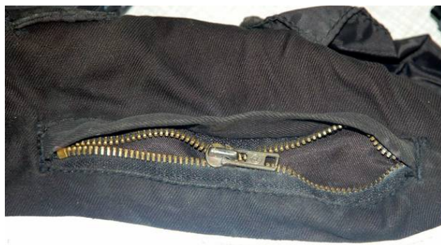
Rys. 8.5. Przykład uszkodzenia zamka błyskawicznego w odzieży niepalnej
