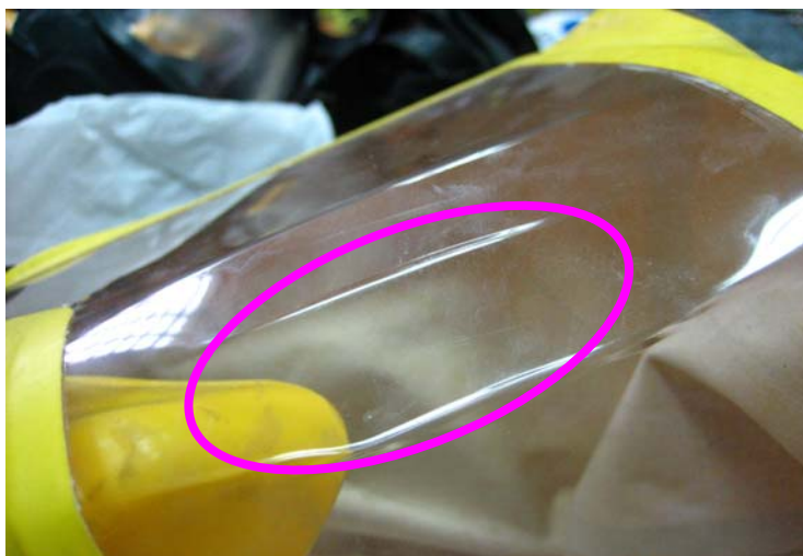
Rys. 5.33. Deformacja szyby wizjera kaptura
