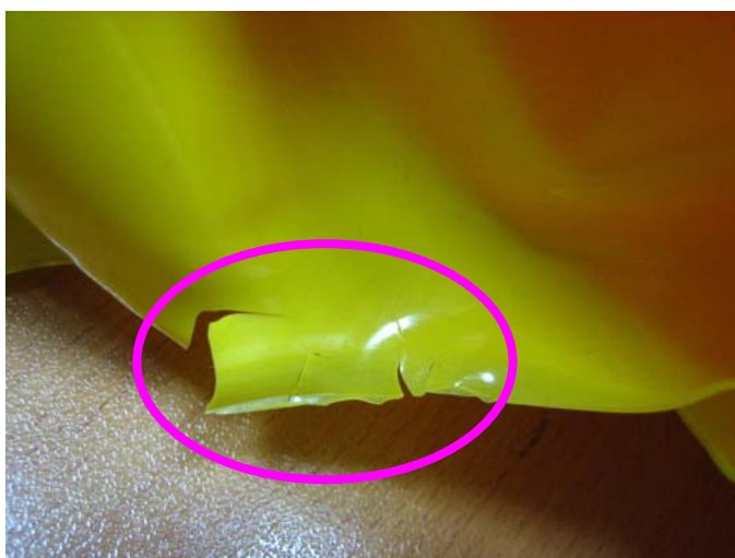
Rys. 5.26. Wyszczerbienie uszczelki szyjnej kaptura
