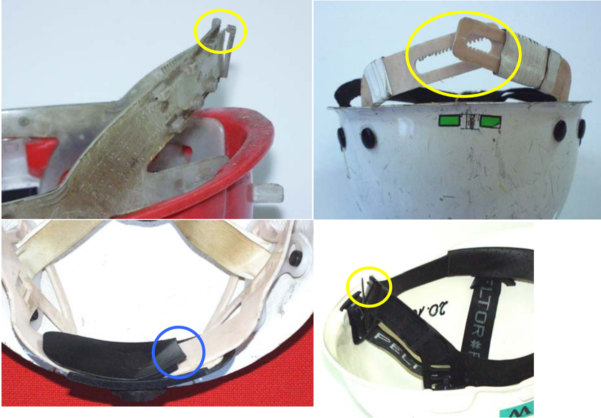
Rys. 2.15. Uszkodzenia regulatorów długości pasów głównych
