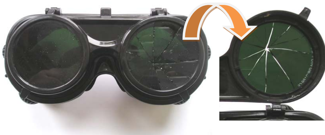
Rys. 4.26. Pęknięty filtr spawalniczy
