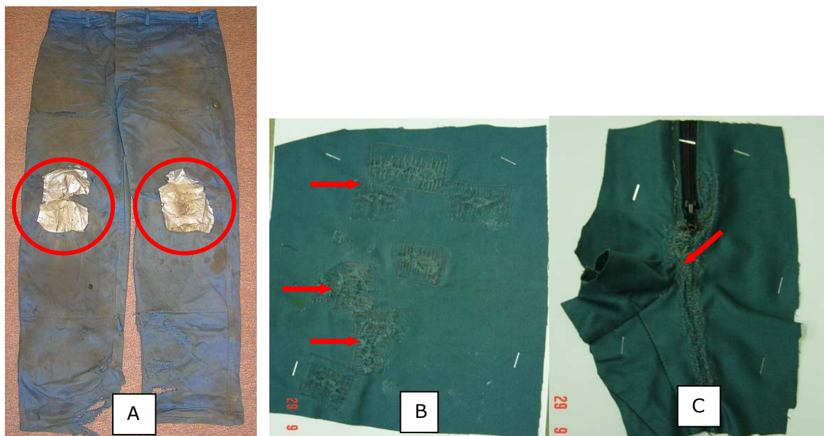
Rys. 8.7 Niewłaściwa naprawa odzieży niepalnej: A – zastosowano taśmy, które się palą – odzież stanowi zagrożenie dla użytkownika; B, C – w miejscu naprawy będą przylegały krople stopionego metalu
