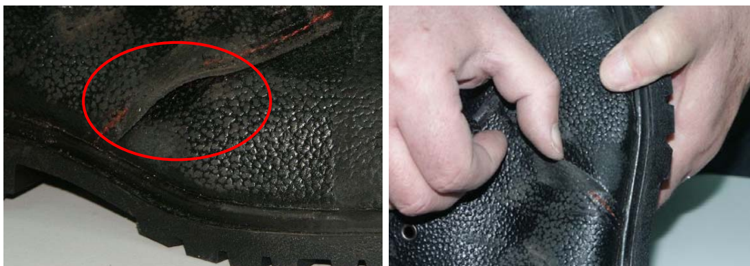
Rys. 7.11. Uszkodzenia szwów łączących elementy obuwia
