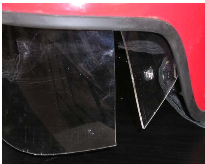
Rys. 4.14. Pęknięcie osłony twarzy zamontowanej w hełmie strażackim
