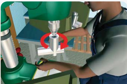
a. Wyślizgnięcie się rozwiercanego przedmiotu z dłoni operatora
