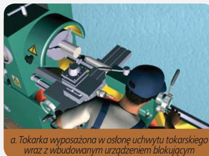
Fot. 4. Komputerowo generowany widok scen prezentujących zastosowane wyposażenie techniczne na stanowisku tokarskim w sekwencji II
