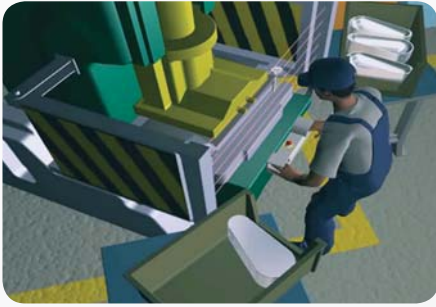
Fot. 9. Komputerowo generowany widok sceny uruchamiania obręcz procesy wykrawania na prasie Photo 9. Computer-generated view of a scene showing two-hand start of a press punching process
