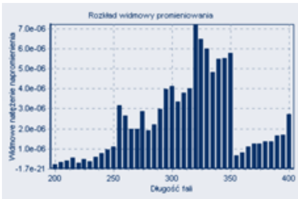
Rys. 3. Wykres gęstości widmowej natężenia napromienienia uzyskany podczas spawania aluminium elektrodą otuloną (do spawania aluminium, \phi = 4 mm), I = 60 A, długość łuku = 6 - 7 mm
