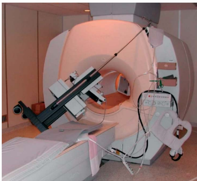
Rys. Z2. Przykład ilustrujący zagrożenia balistyczne – typowa pompa infuzyjna (MR Unsafe), stwarzająca zagrożenie w pomieszczeniu diagnostycznym, została przyciągnięta przez magnes S-RM [9, za zgodą F.G. Shellock]
