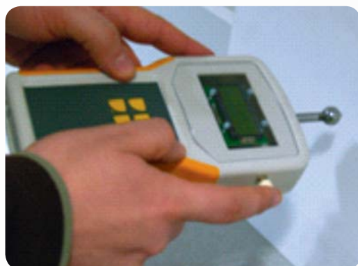
Fot. Miernik ładunku ES, z ekranowaną elektrodą, o rozdzielczości 0,1 nC i zakresie 0 – 10 µC, opracowany w CIOP-PIB (zadanie 05.B.1, II etapu programu wieloletniego „Poprawa bezpieczeństwa i warunków pracy”)
