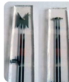
Rys. 5. Prototypy czujników pola elektromagnetycznego w paśmie 60-90 GHz, skonstruowane w LWiMP
