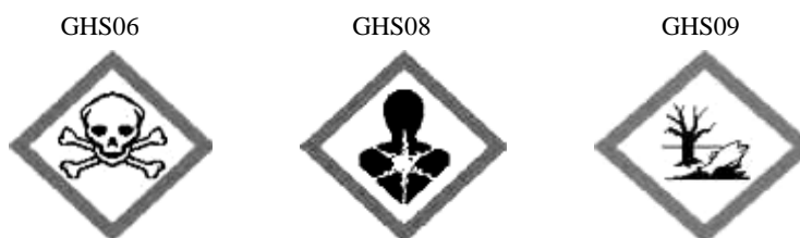
Rys. 1. Kod hasła ostrzegawczego: „Uwaga”. Piktogramy określone w załączniku do rozporządzenia WE 1272/2008 (CLP) mają czarny symbol na białym tle z czerwonym obramowaniem, na tyle szerokim, aby było wyraźnie widoczne
